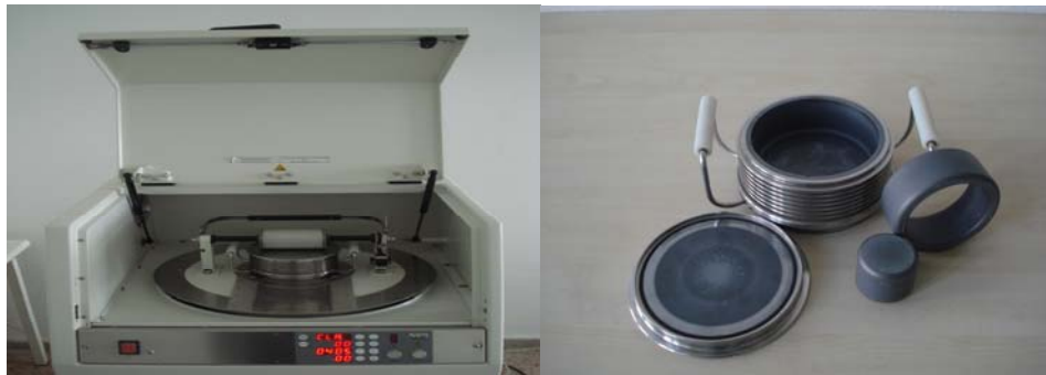
Şekil 3.4. Titreşimli halkalı değirmen ve tungsten karbit öğütme seti
