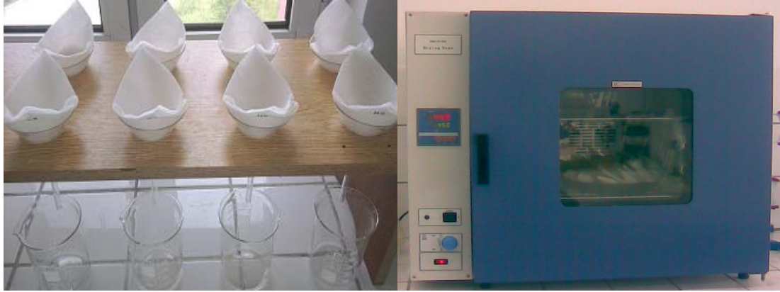
Şekil 3.6. Numunelerin liç işlemi sonrası filtrasyonu ve kurutulması
