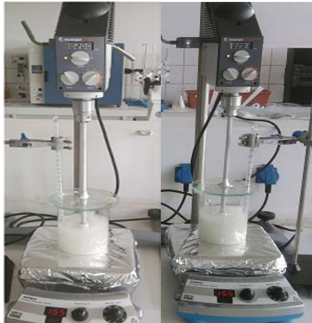
Şekil 3.5. Kimyasal liç deney düzeneđi
