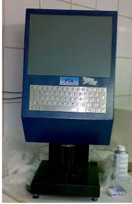
Şekil 3.2. Beyazlık test cihazı
