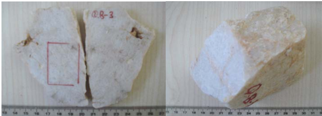
Şekil 4.2. Kuvars cevherinin makroskobik incelemesi
