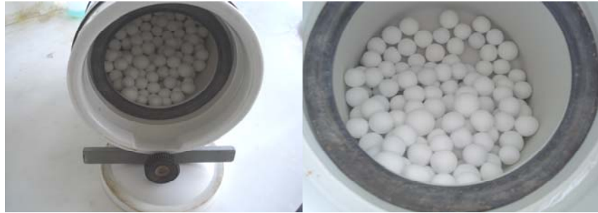
Şekil 3.3. Bilyeli değirmen ve alümina bilyeler
