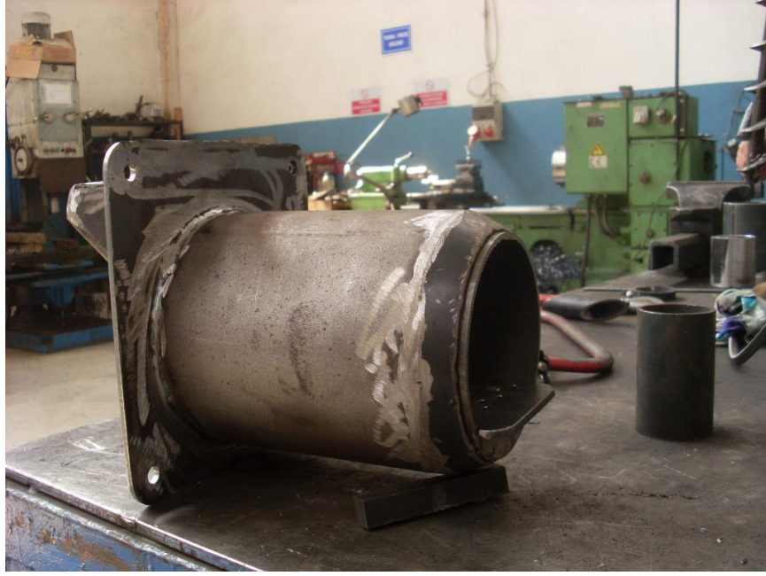
Şekil 4.3. Bağlantı flanşı ve dış cidar borusu montajı
