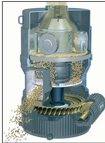
Şekil 2.8. Pelet presleme makinesinin kesit görünümü
