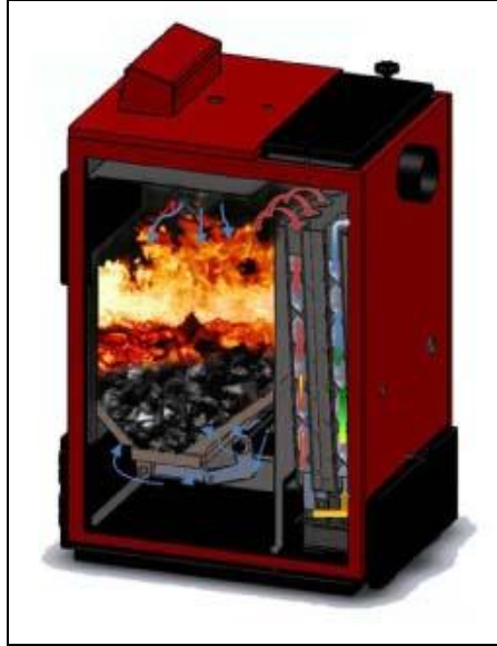
Şekil 3.2. Üç geçişli, kömürlü bir alev duman borulu sıcak su kazanının kesiti (Esendir, 2011)
