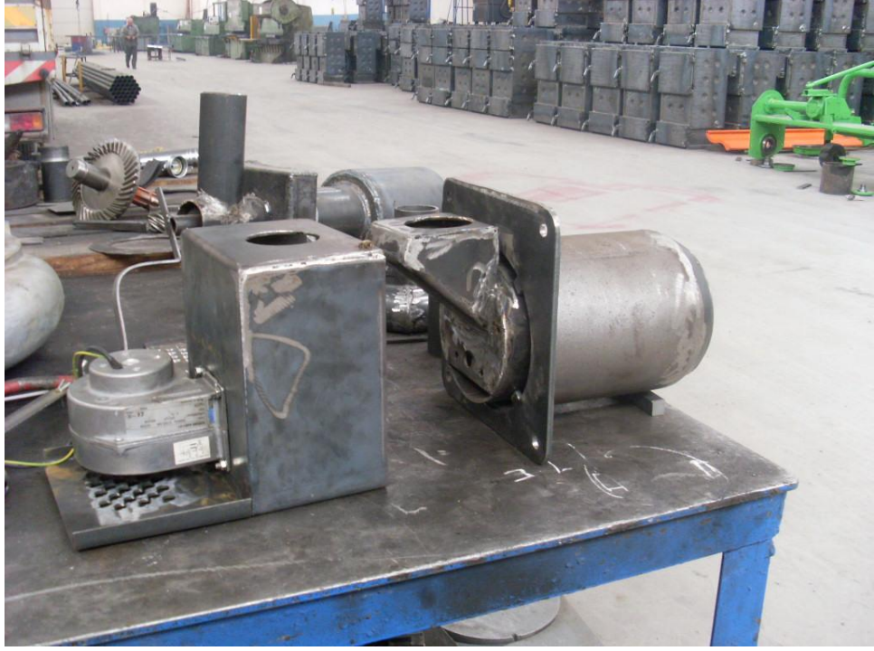
Şekil 4.5. Fanın hava kutusuna montajı
