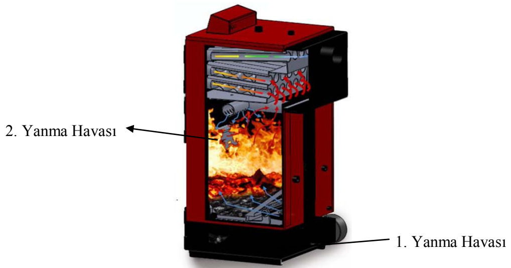
Şekil 2.10. Sabit ızgaralı elle yüklemeli katı yakıt kazanının kesit görünümü (Esendir, 2011)
