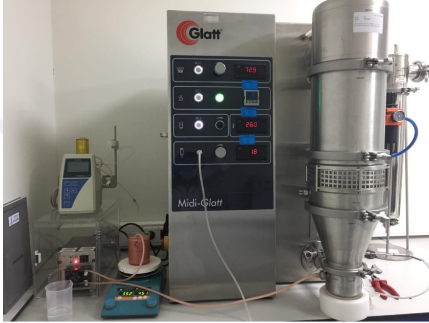
Resim 2. Wurster metodu ile kaplama yönteminde kullanılan cihaz
