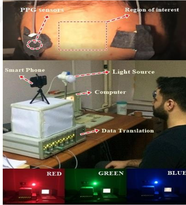
Şekil 13: Akıllı telefon kamerası ve PPG aygıtı deney kurulumu
