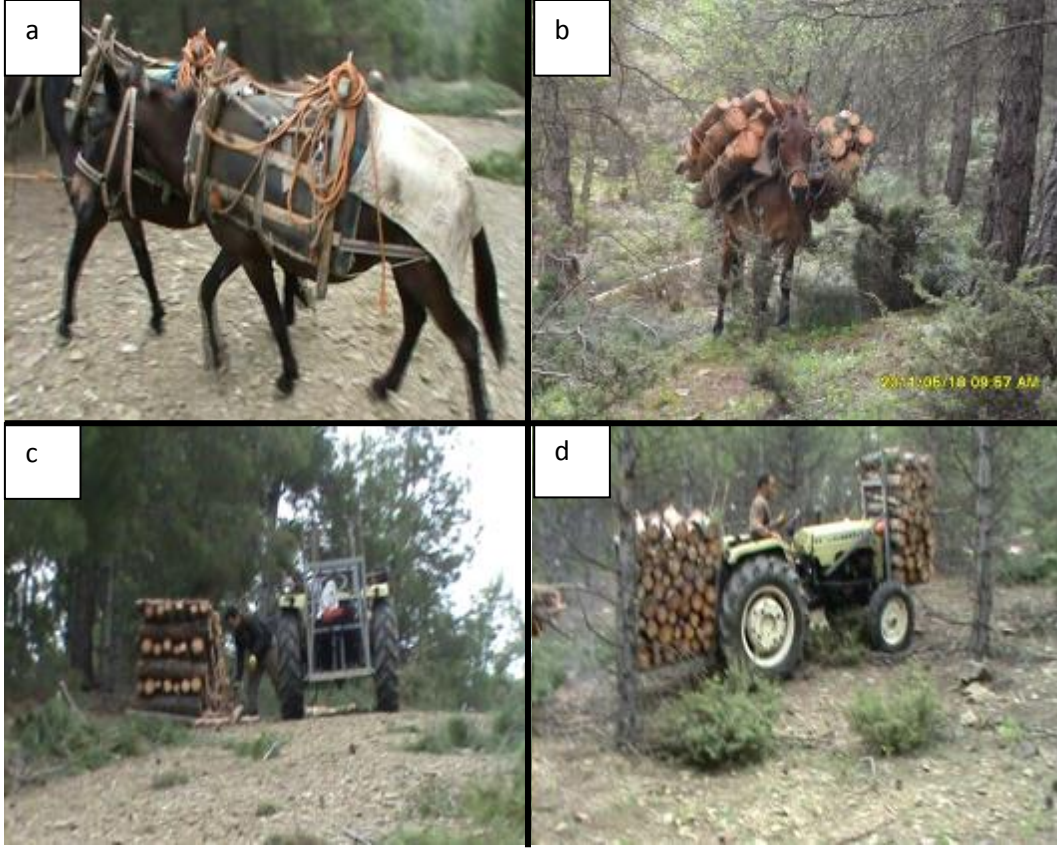
Şekil 4.11. Bakım kesimlerinde ster odununun bölmeden çıkarılması, a) Katır boş gidiş, b) Katır dolu dönüş, c) Ster odunların indirilmesi, d) Traktörle ster odunların bölmeden çıkarılması.
