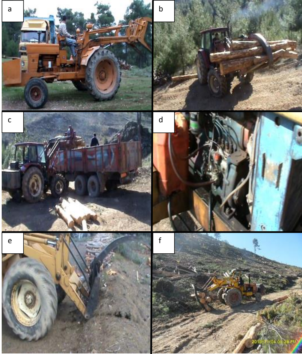
Şekil 4.6. Kıskaçlı yükleyici, a) Yükleyici boş gidiş, b) Yükleme, c) İndirme, d) Yakıt miktarı ölçümü, e) Bölme içi hareket için hazırlık, f) Tomrukları sıkıştırma.
