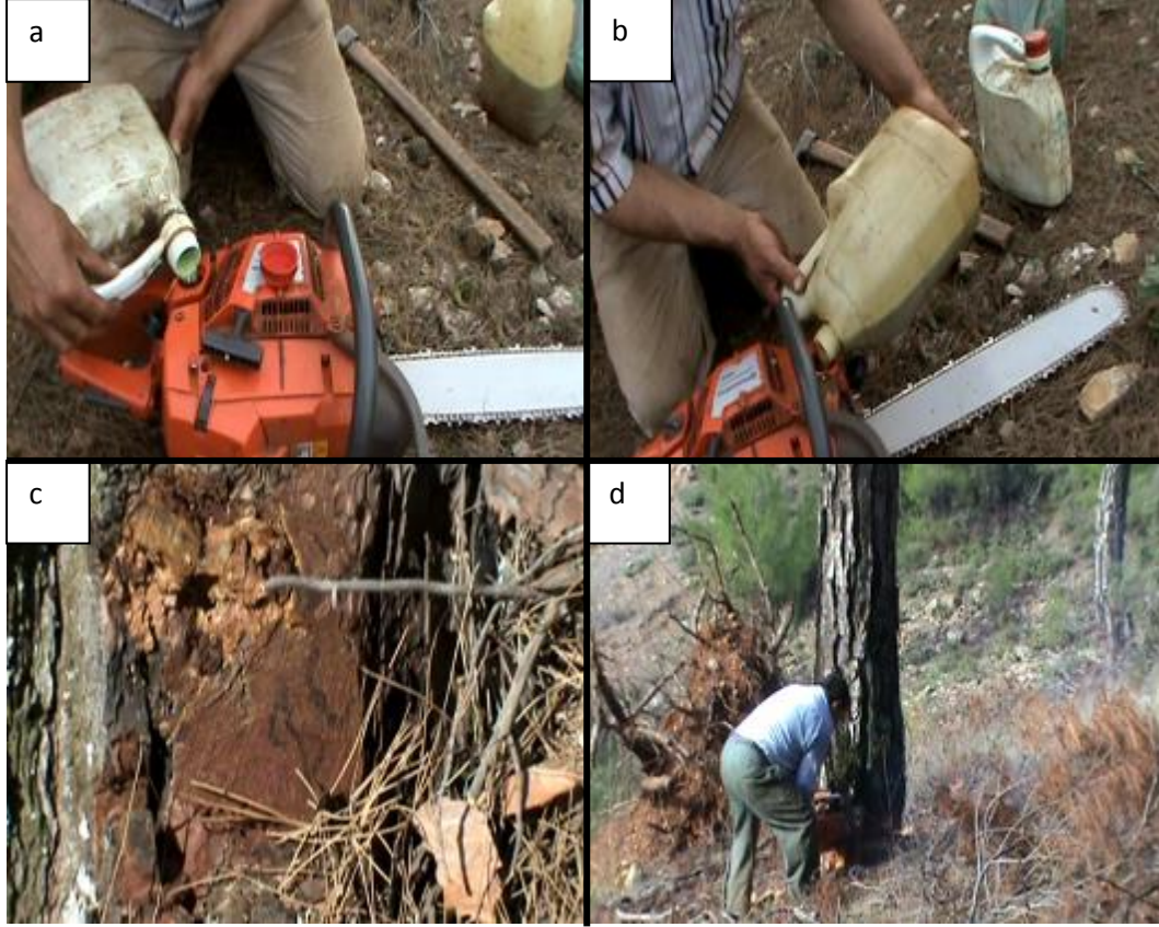
Şekil 4.2. Kesme-tomruklama, a) Motorlu testereye benzin ikmali, b) Motorlu testereye yağ ikmali, c) Ağaç numarası, d) Devirme kesişi.
