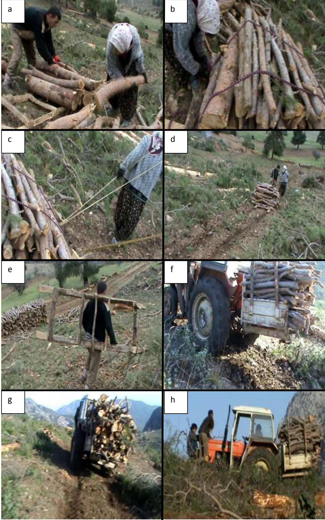
Şekil 4.5. Ster ürünlerin bölmeden çıkarılması, a) – b) – c) – d) – e) Kızakla bölmeden çıkarma, f) – g) – h) Traktör ile bölmeden çıkarma.
