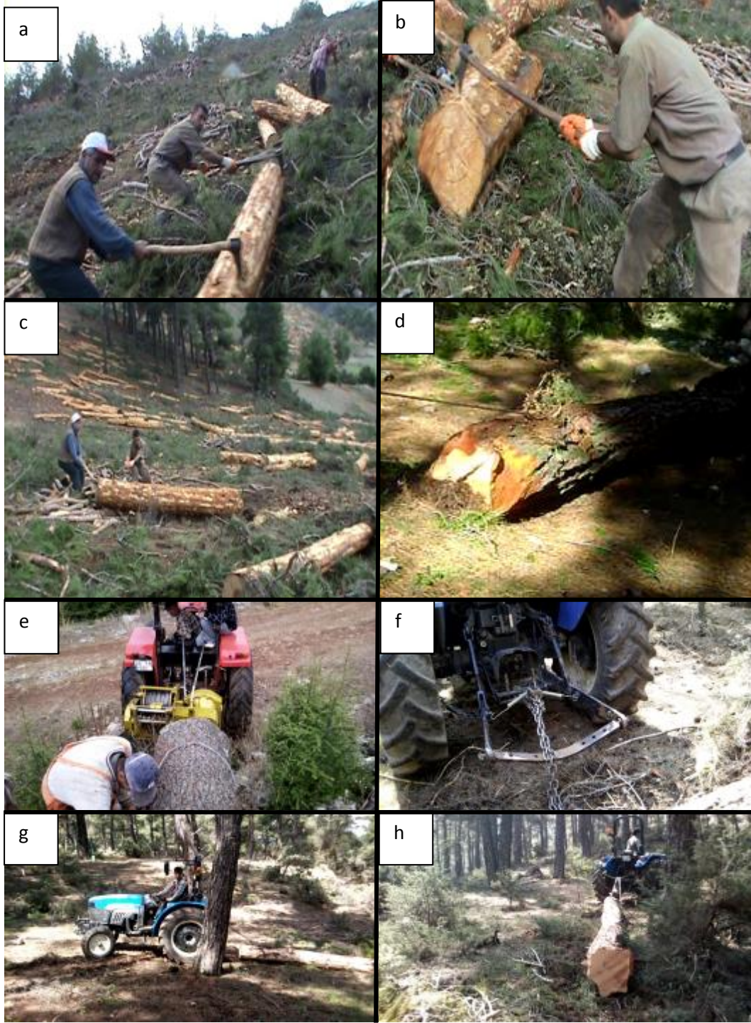
Şekil 4.4. Tomrukların sürütülmesi, a) Sapınle çekme, b) Yuvarlama, c) Sapınle yerçekimi etkisinden yararlanılarak kaydırma, d) Kablo ile tomrukların sürütülmesi, e) Kablunun çözülmesi, f) Traktöre zincirin bağlanması, g) - h) Zincir ile tomrukların sürütülmesi.
