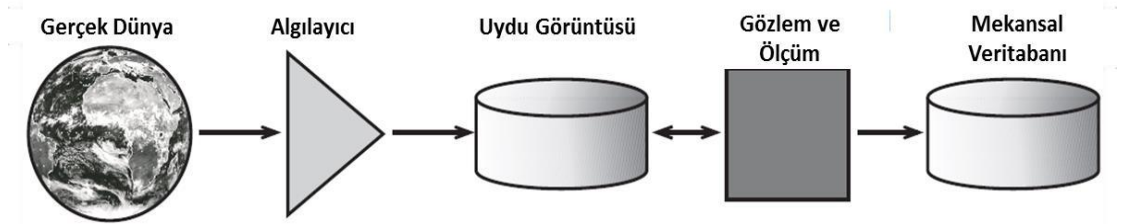
Şekil 3. Uzaktan algılamanın işleyiş süreçleri
