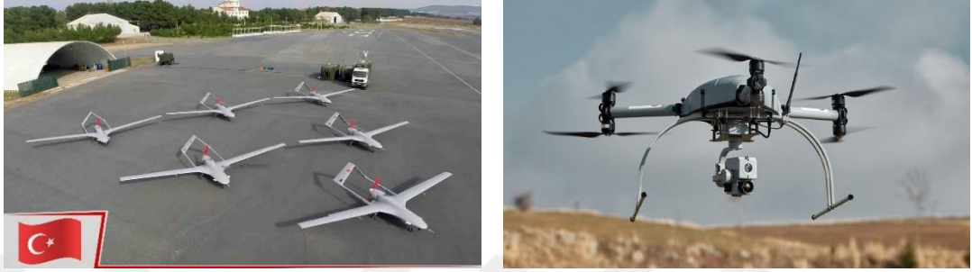
Şekil 4. (a) Sabit Kanat İHA ve (b) Döner Kanat İHA
