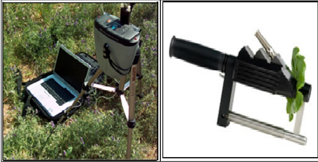
Şekil 3.2. Spektroradyometre ölçüm seti (Dedeoğlu, 2011)
