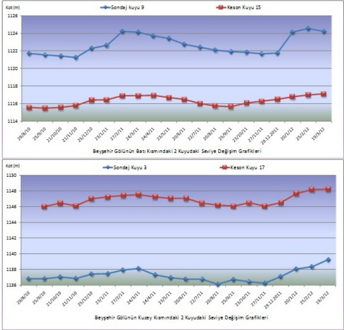
Şekil 3. 19. Gölün Batı ve Kuzey yönlerindeki kuyuların YASS seviyelerinin zamanla değişimleri
