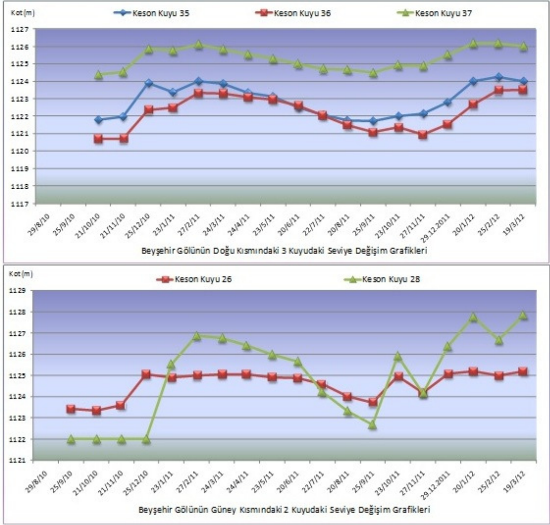
Şekil 3. 18. Gölün Doğu ve Güney yönlerindeki kuyuların YASS seviyelerinin zamanla değişimleri
