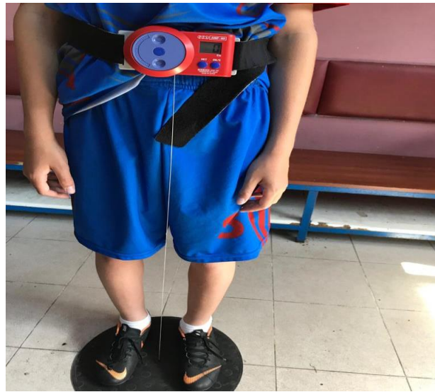
Resim 9: Jumpmeter dikey sıçrama ölçümü
