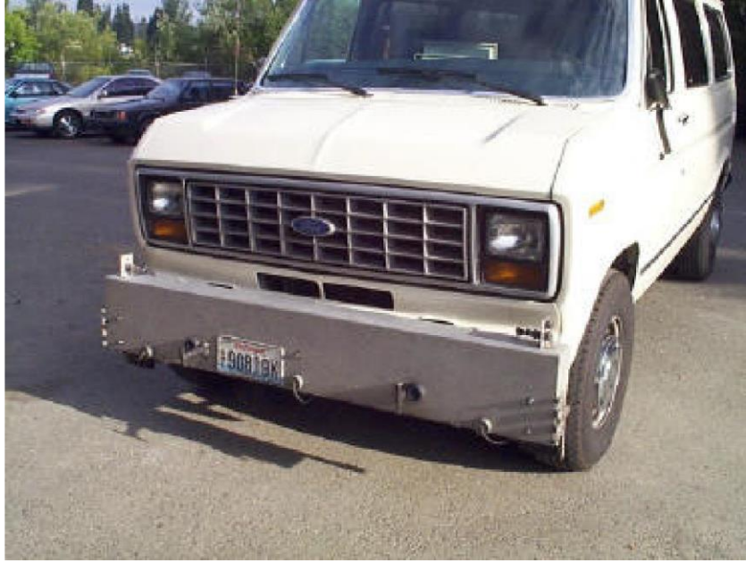
Şekil 3.2. Ultrasonik profilometre aracı
