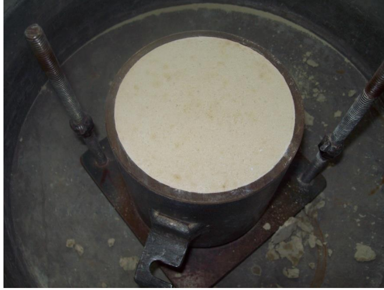
Şekil 3.5. Kompaksiyon sonrası sıkıştırılmış numune
