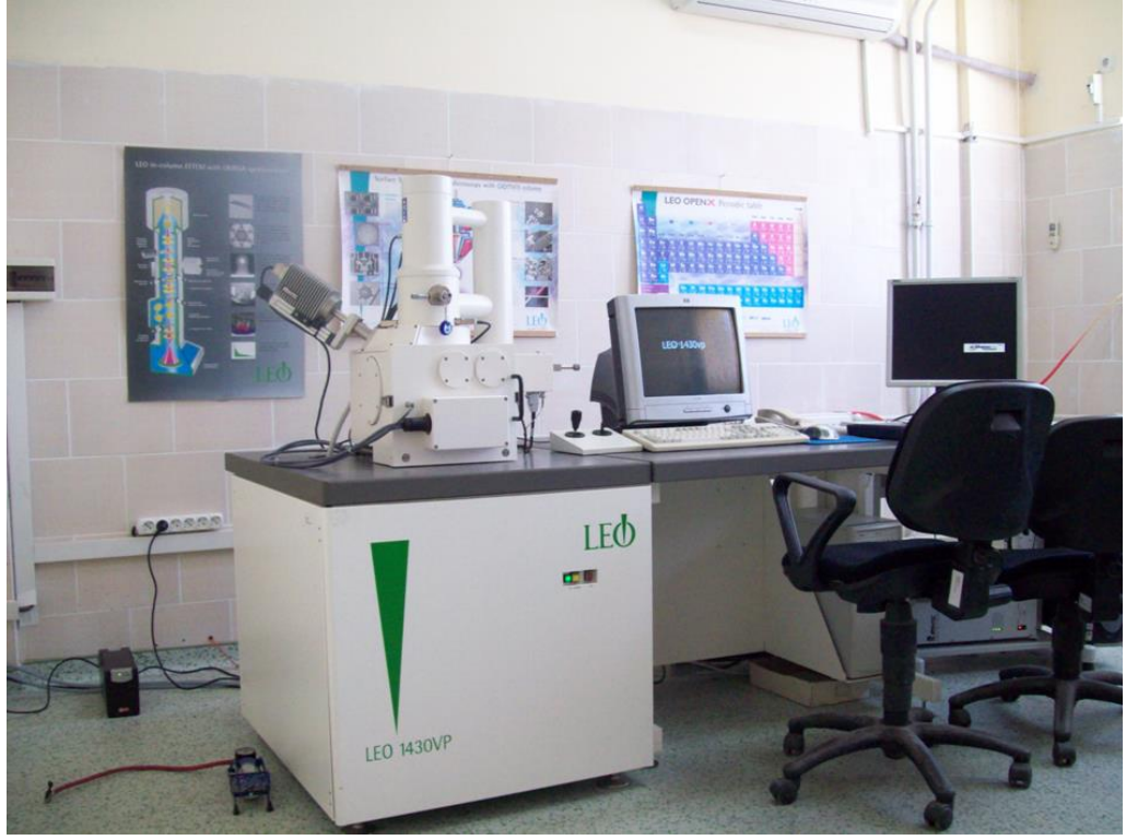
Şekil 3.8. LEO 1430VP marka SEM analiz cihazı
