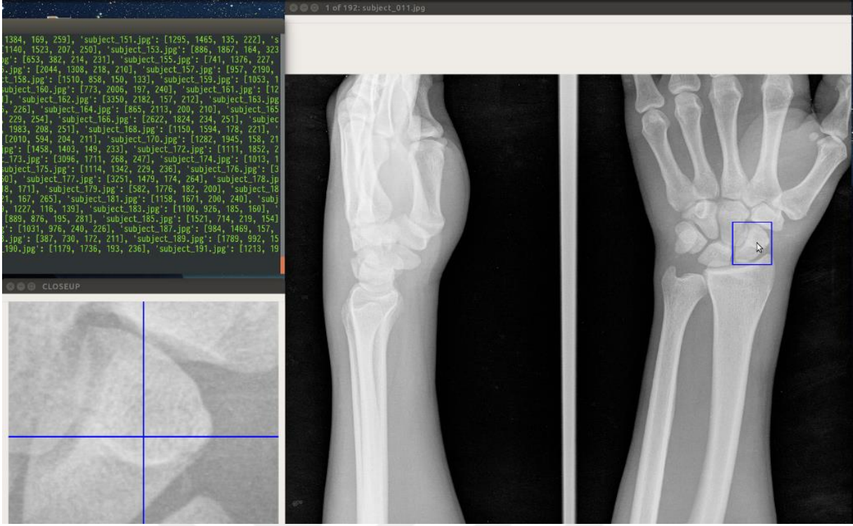
Şekil 18 Skafoid bölgesini içeren dikdörtgen bir alanın seçimine yardımcı olmak için, her radyogram fare imlecinin çevresindeki görüntü alanının yakınlaştırılmış bir versiyonunu gösteren bir ayrıntı penceresi ile birlikte görüntülenir. Radyolog, daha sonra bir kenarlıkla genişletilen, kırılan ve 196 x 196 piksel nihai veri kümesi görüntü boyutuna ölçeklendirilen skafoid çevresinde sıkı bir dikdörtgen alanı işaretler.
