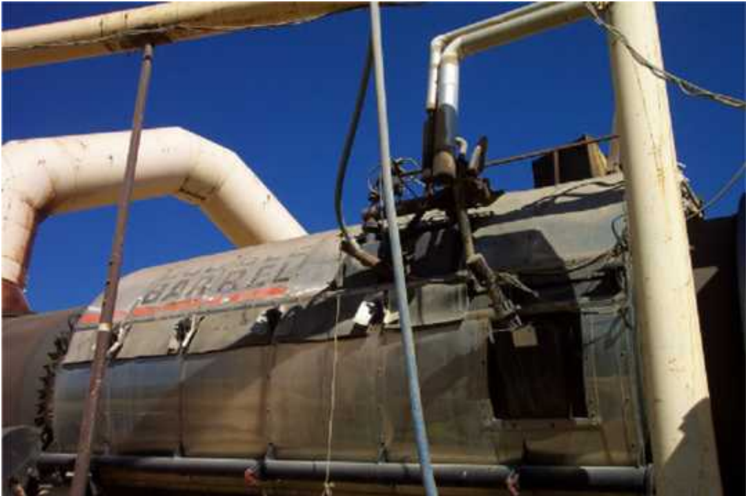
ekil 3.6. Sasobit balmumu eklenmesi (Burke, 2005)
