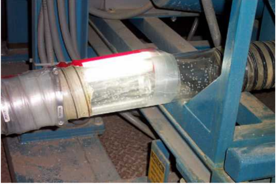
ekil 3.7. Tüp besleyici içinde akan Sasobit (Burke, 2005)
