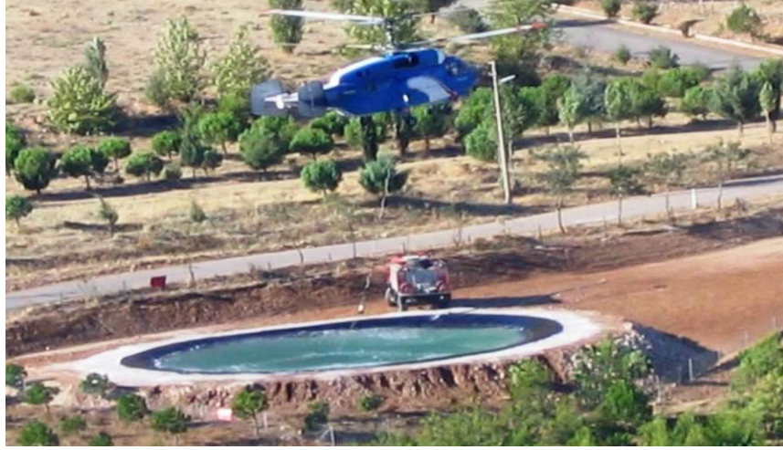
Şekil 4.22. KA-32 helikopterinin yangın havuzundan su alımı (Anonim, 2012c)
