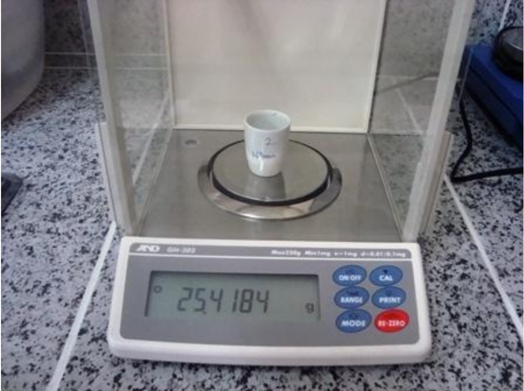
Şekil 3.21. Desikatörde soğutulan krozenin hassas terazide tartılması
