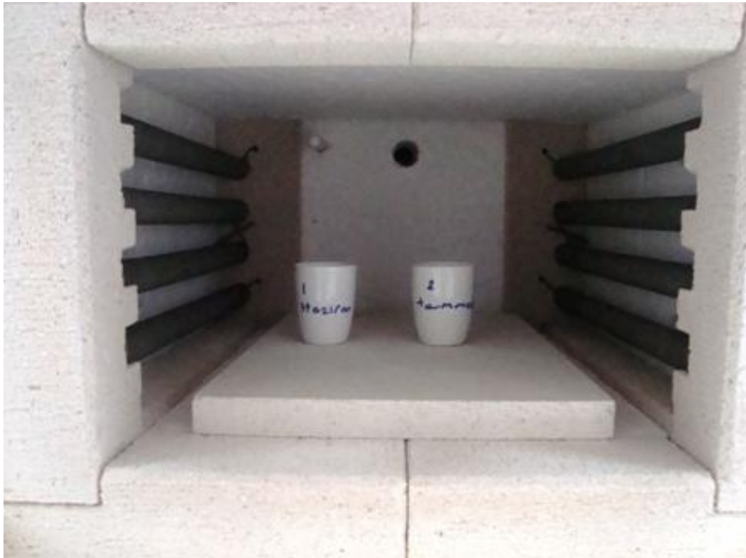
Şekil 3.22. Çamur numunelerinin kül fırınına yerleştirilmesi-1
