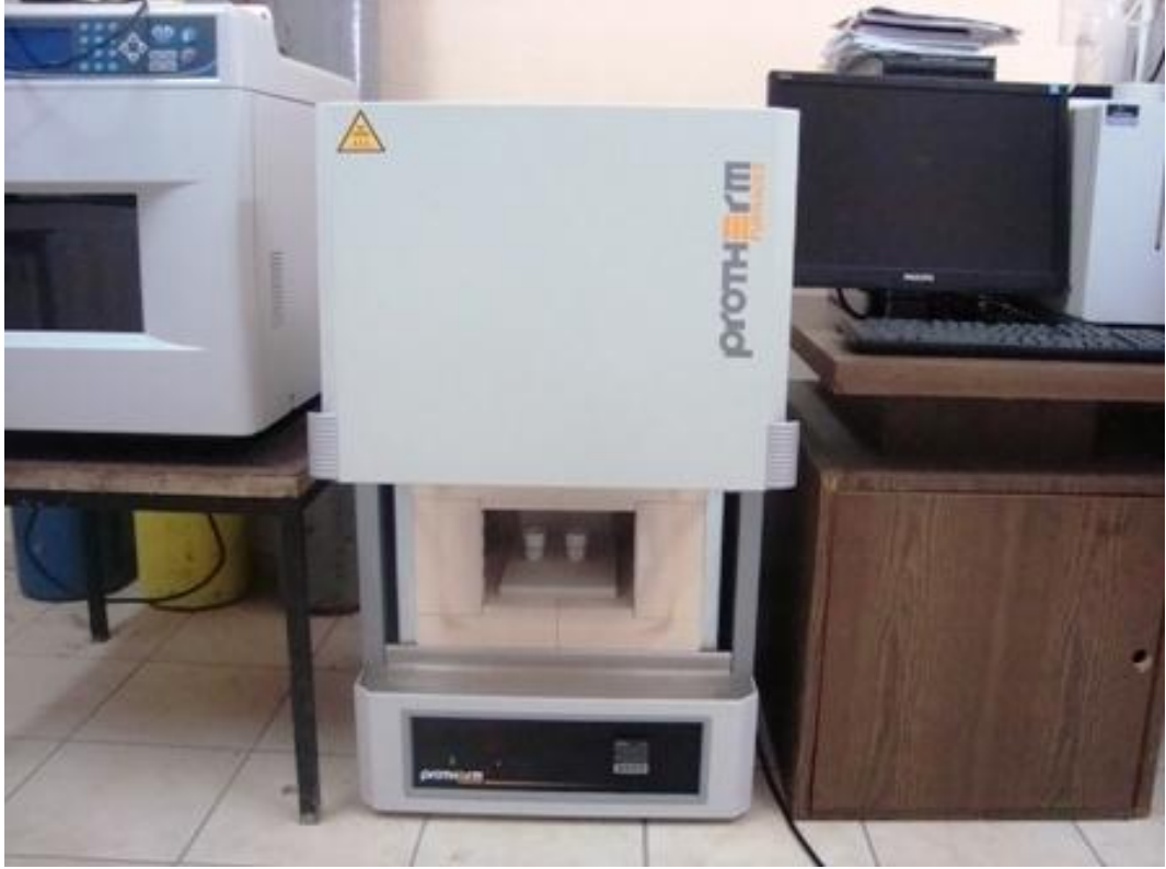
Şekil 3.23. Çamur numunelerinin kül fırınına yerleştirilmesi-2
