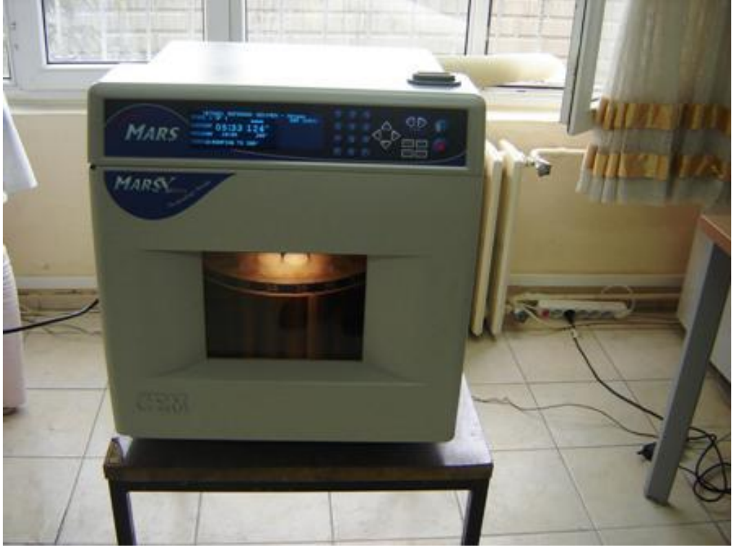
Şekil 3.29. Çalışmada kullanılan CEM, MarsXpress mikrodalga fırını
