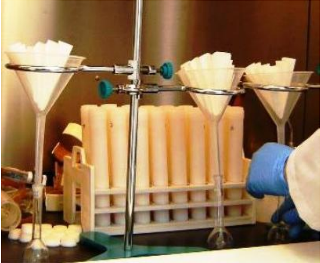
Şekil 3.30. Çamur numunelerinin filtre kağıdından süzülmesi
