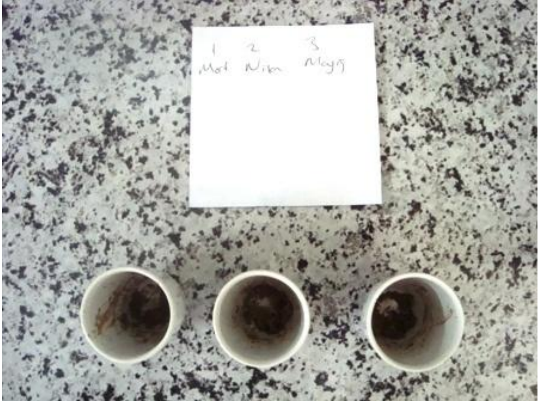
Şekil 3.24. Kül fırınından çıkmış ve desikatörde soğutulmuş çamur numuneleri
