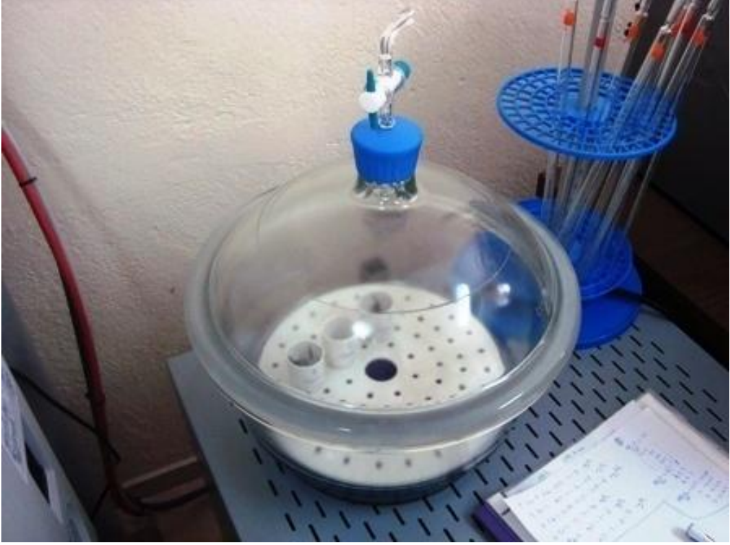
Şekil 3.20. Çamur numunelerinin desikatörde oda sıcaklığına kadar soğutulması
