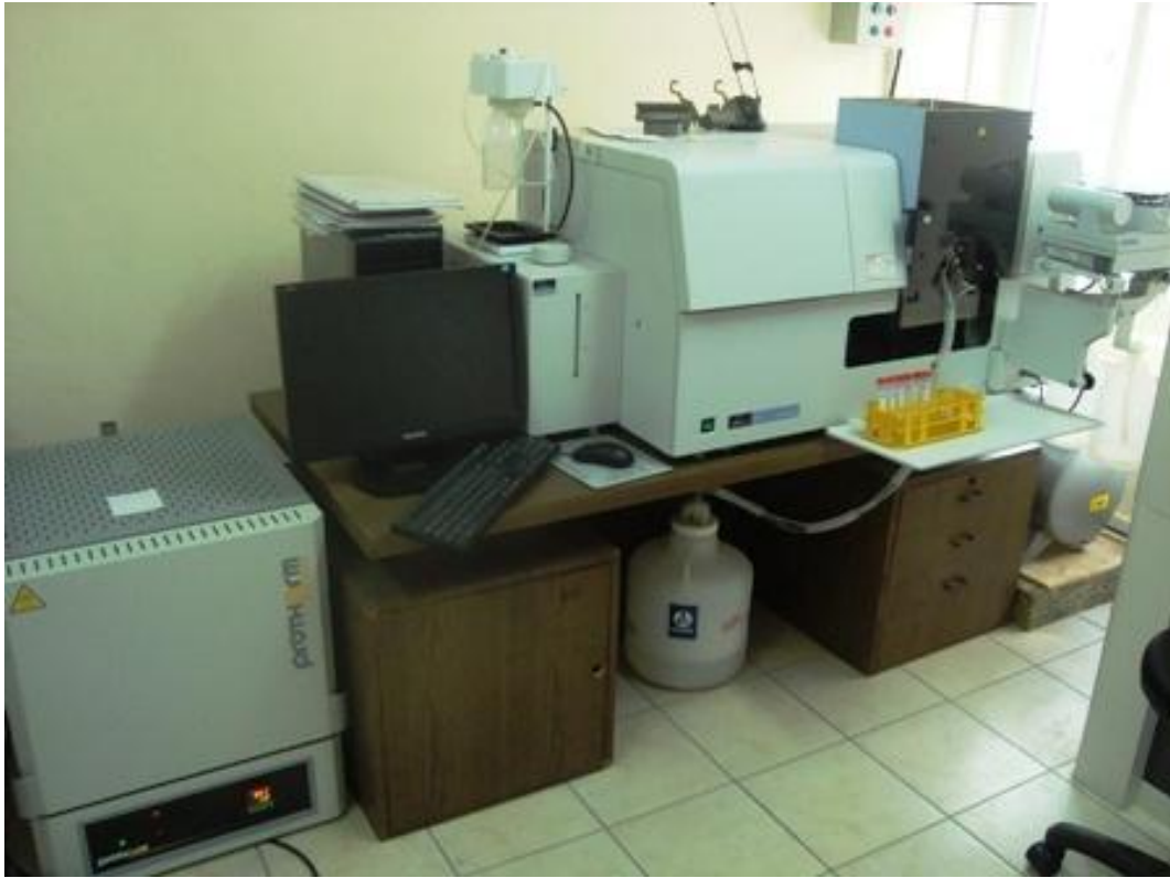
Şekil 3.31. Ağır metal analizlerinin gerçekleştirildiği AAS cihazı
