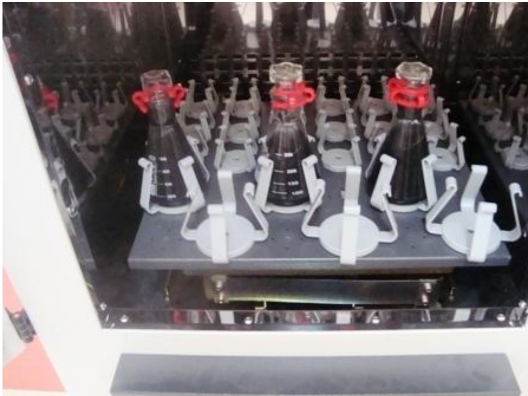
Şekil 3.25. Çalkalayıcıya yerleştirilmiş çamur numuneleri
