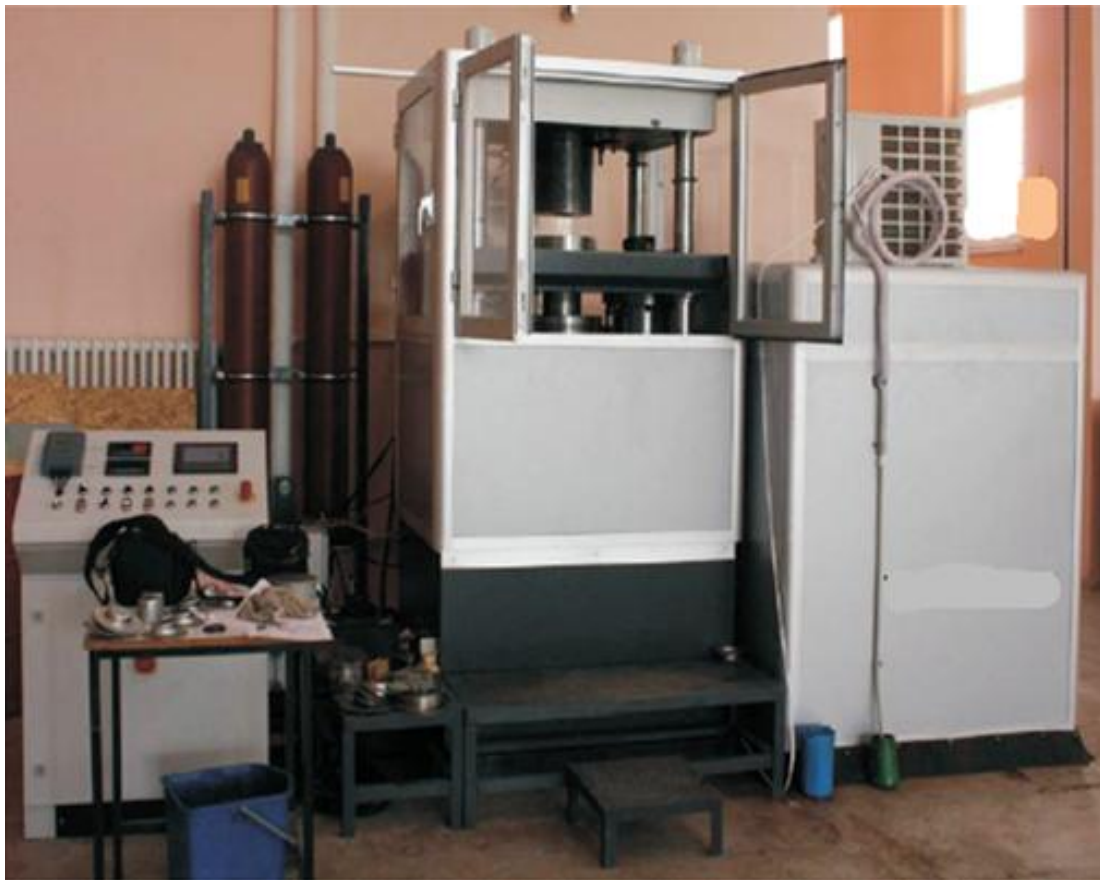
Şekil 3.16. Sürtünme testlerinin gerçekleştirildiği pres
