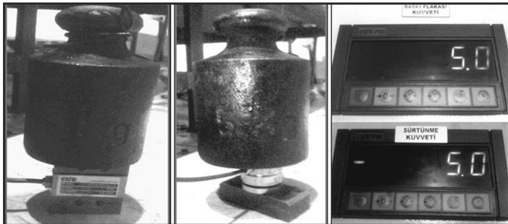
Şekil 3.14. Yük hücrelerinin üzerine 5 kg kütle konularak kontrol ünitesinde doğrulanması
