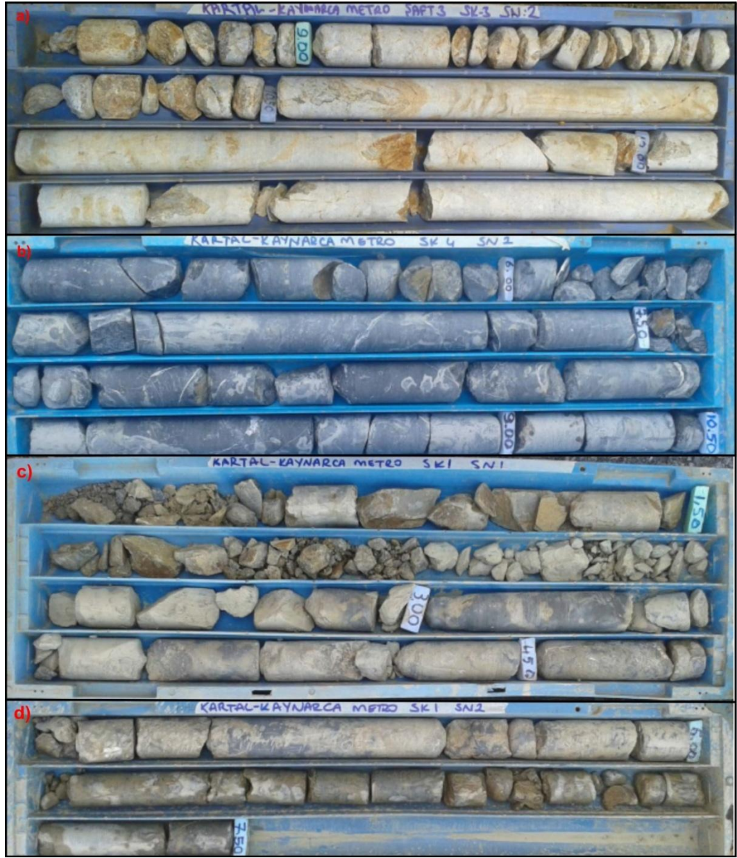
Resim 4.4. Çalışma alanında jeoteknik sondaj karotları genel görünümü (a; yumrulu kireçtaşı, b; Yakacık İstasyonu bölgesinde gözlenen grovaklar, c-d Pendik İstasyonu grovak ara tabakalı karbonatlı şeyller)
