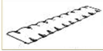
Şekil 2.20. Fazla (-) bombe nedeniyle levhanın kenarlarında oluşan dalgalanma ( Gülenç2012)
