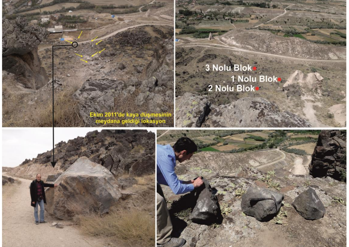
Resim 4.8 Kaya düşme deneyi ve kaya düşmesi olayının genel görünümü
