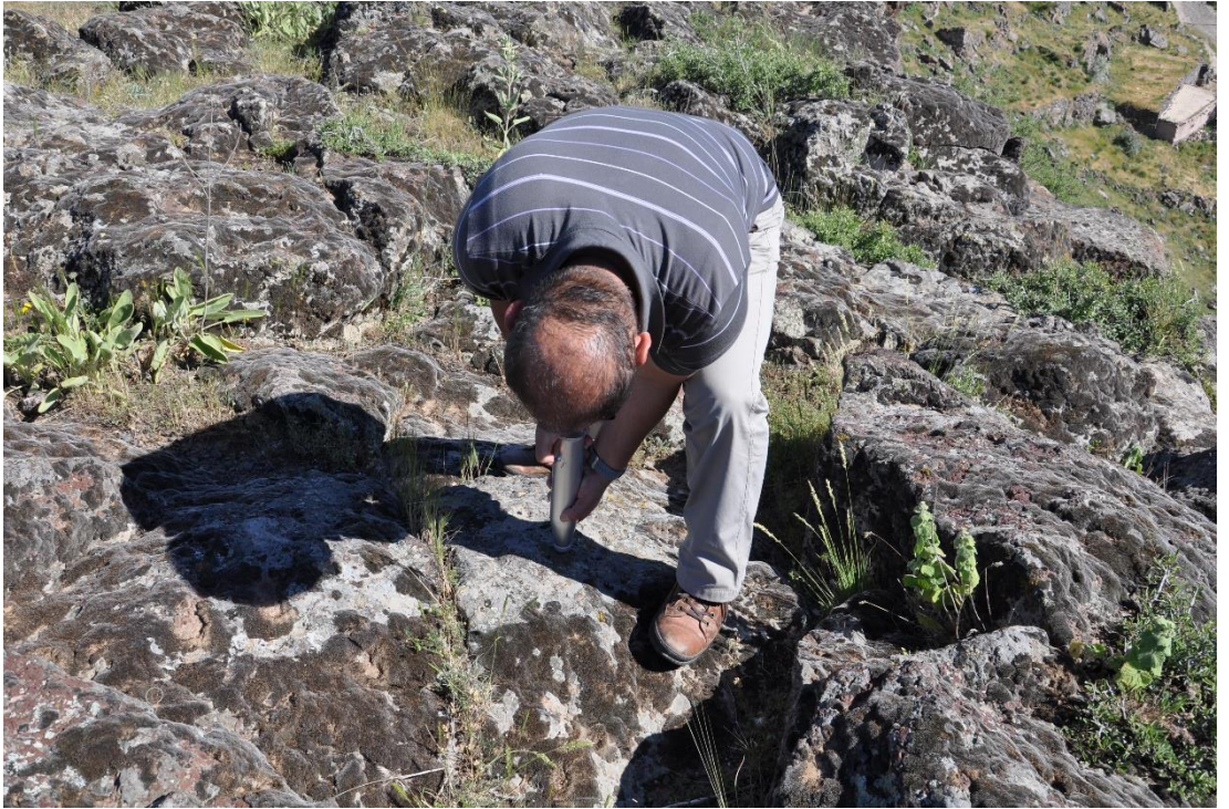
Resim 3.2 Çalışma alanında Schmidt çekici ile yüzey mukavemetinin belirlenmesi
