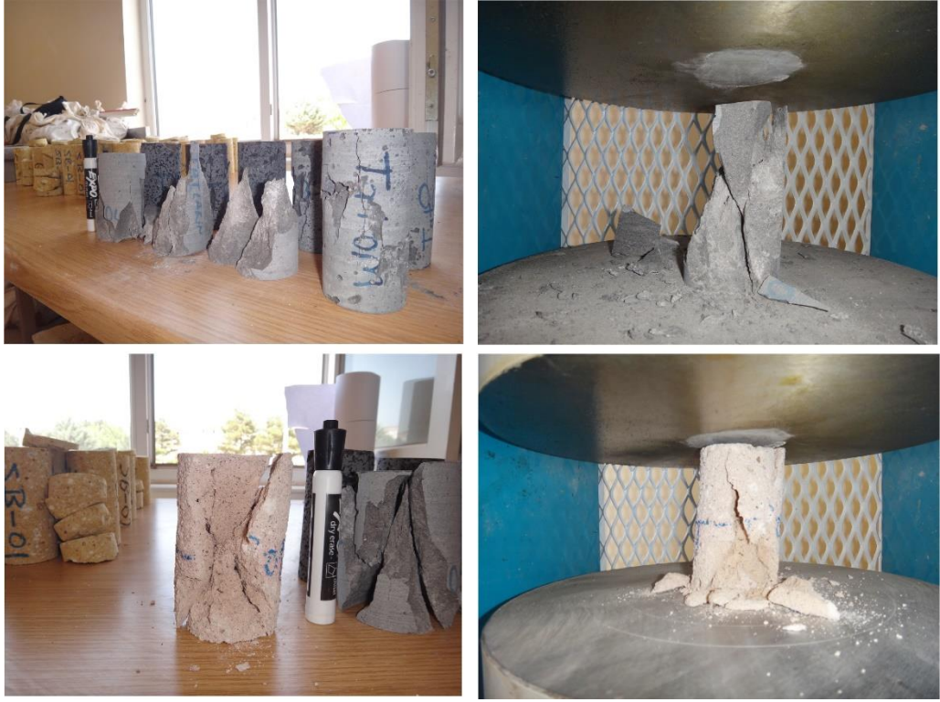
Resim 4.2 Kaya örneklerinin tek eksenli sıkışma deneyi sonrası görünüşleri
