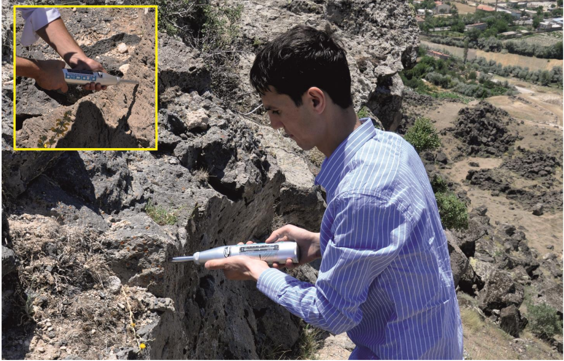
Resim 4.6 Arazide süreksizlik yüzeylerinde Schmidt çekicinin uygulanması
