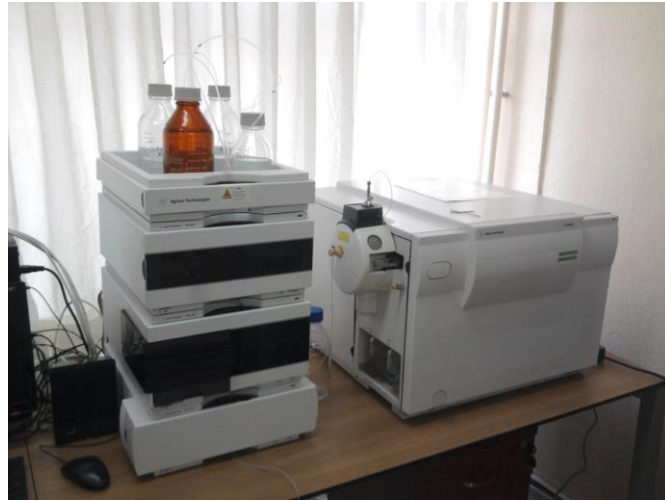
Şekil 3.6. Sıvı kromatografi kütle spektrometre dedektörü (Agilent)
