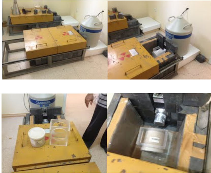
Resim 3.2. Radyoaktivite ölçümünde kullanılan HPGe dedektörlü gama spektrometresi
