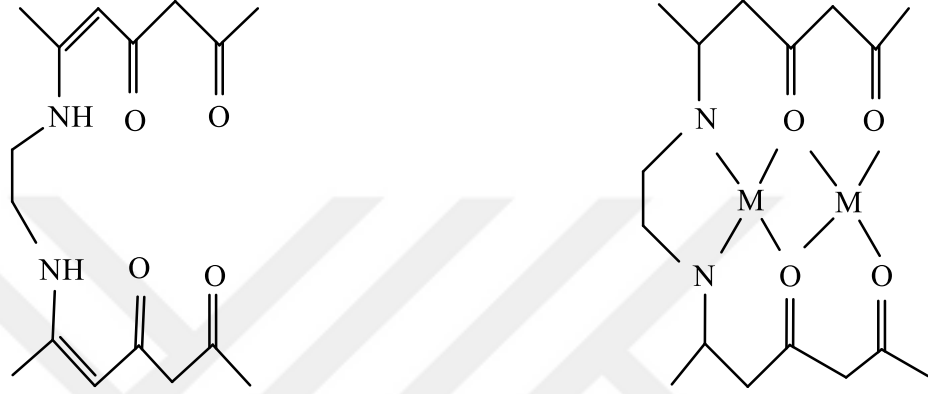
Şekil 2.11. Kompartıman tipi Schiff bazları
