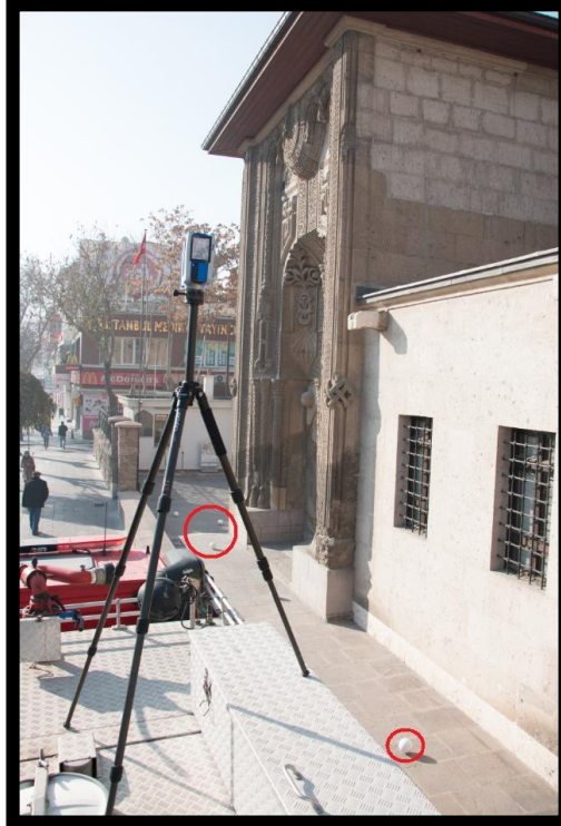
Şekil 5.8. Lazer Tarayıcı ve Özel Yansıtıcı Küre Hedefler.
