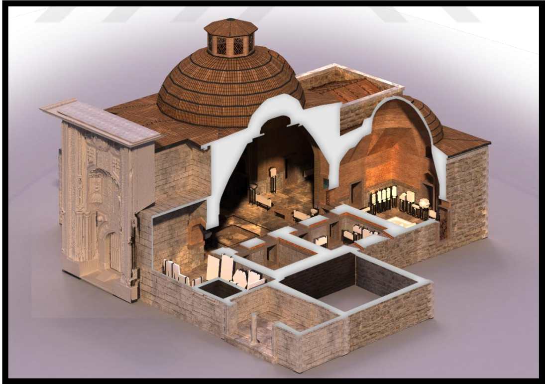
Şekil 5.60. LoD-4 Seviyesinde Modelden Kesit Görünüşü
