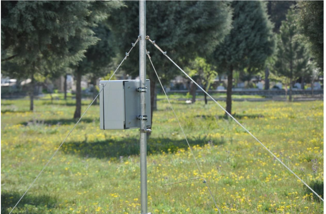
Şekil A.2. İstasyona ait Data Logger kutusu.
