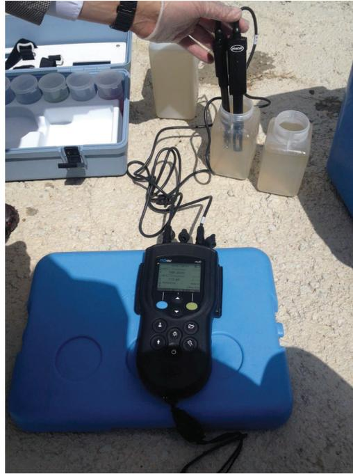
Resim 3.5 Atıksu kanal çıkışının pH ve sıcaklık ölçümü
