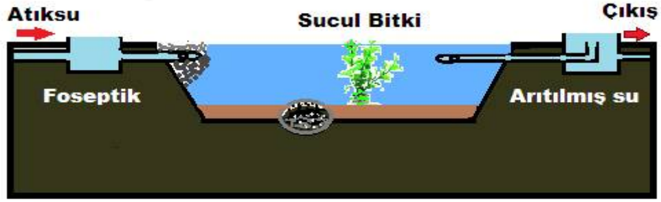
Şekil 2.10. Doğal arıtma sistemi [61]
