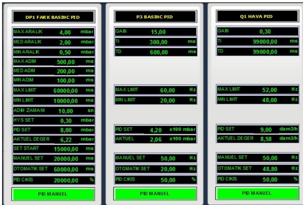
Şekil 3.19. SCADA ekranında PID parametreleri görüntüsü
