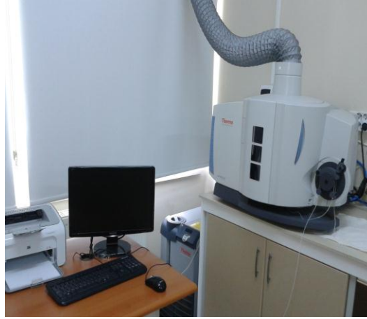
Şekil 3.5. Çalışmada kullanılan ICP-OES cihazı.
