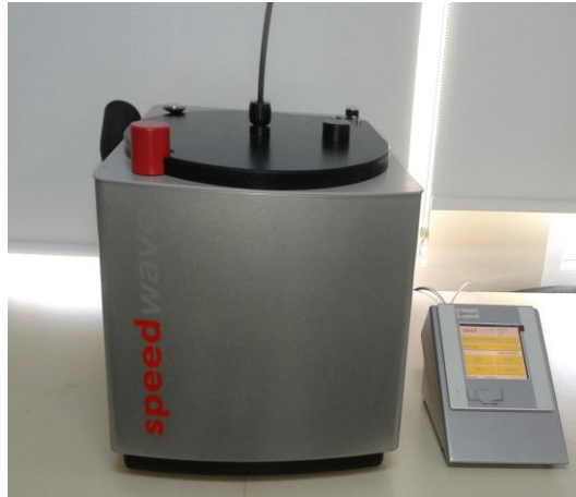
Şekil 3.4. Çalışmada kullanılan mikrodalga yakma cihazı
