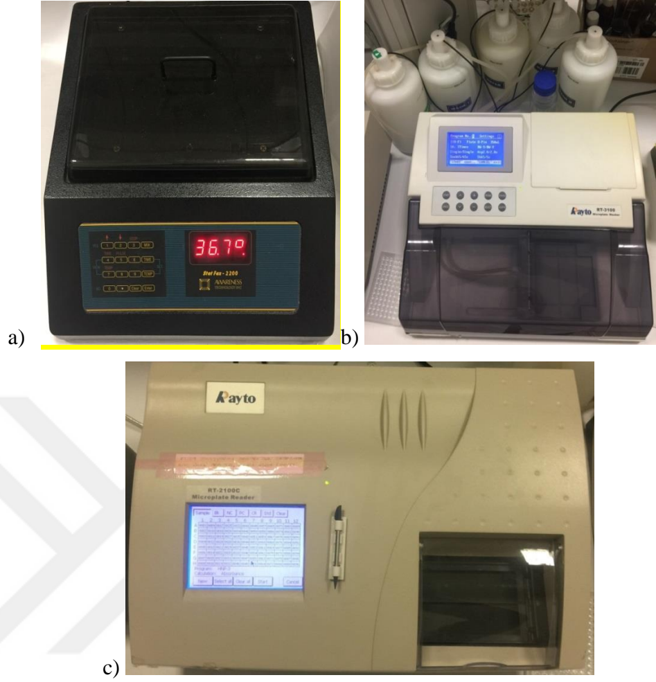
Resim 14: Alfa amilaz, Karbonik anhidraz VI ve HNP 1-3 ELISA kiti için karıştırma(a), yıkama(b) ve okuma(c) cihazları
