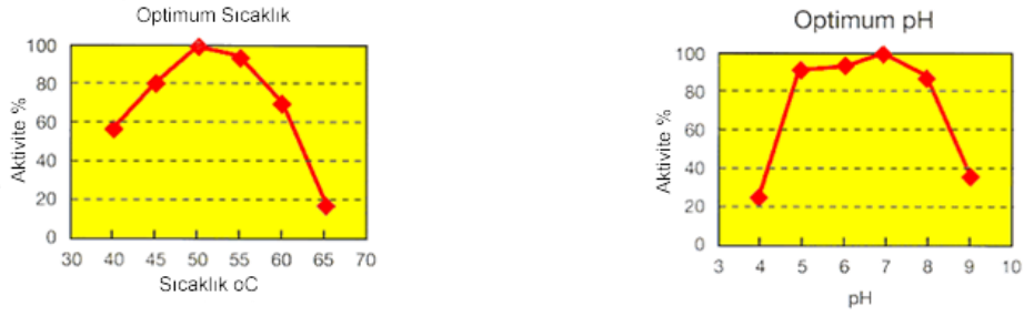
Şekil 2. 6. Mikrobiyal transglutaminaz enziminin optimum pH ve sıcaklık değerleri (Ajinomoto, 2005)
