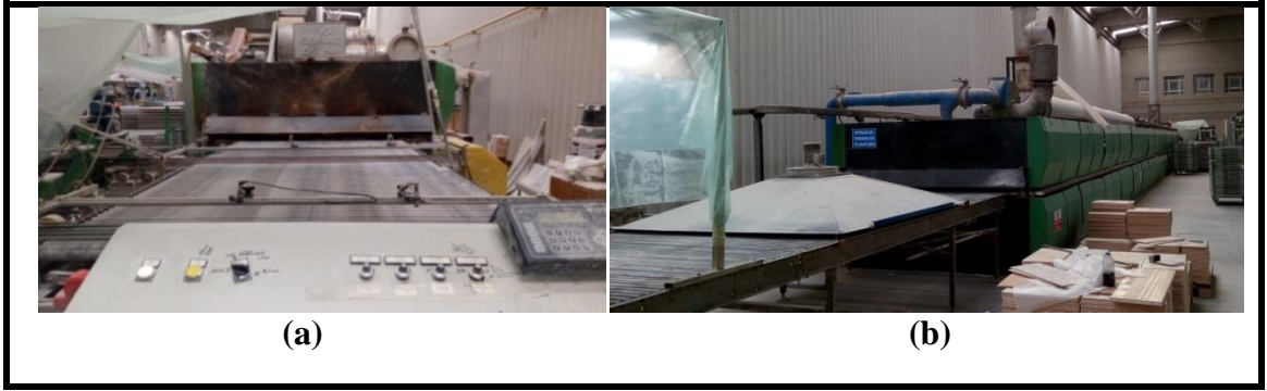
Resim 3.2. Endüstriyel Roller fırın a) giriş b) çıkışı.
