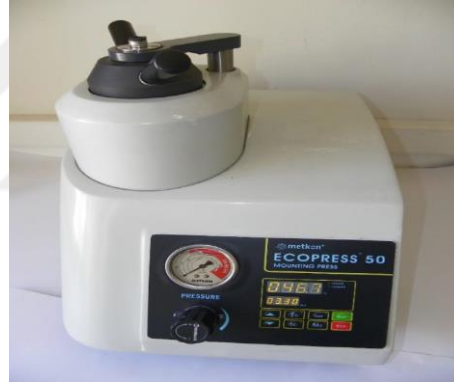
Şekil 4.11. Metkon Ecompress 50 sıcak bakalit kalıplama
