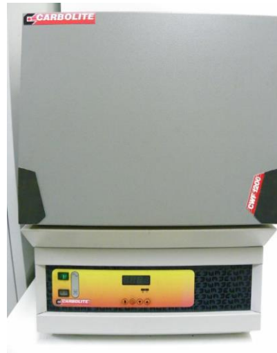
Şekil 4.2. Carbolite yüksek sıcaklık fırını
