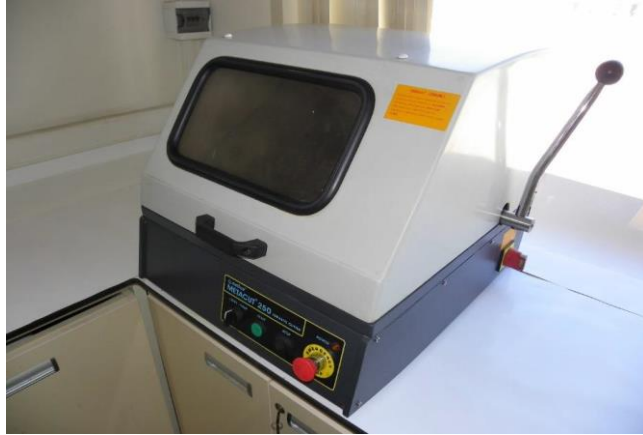
Şekil 4.8. Metkon Metacut 250 metalografik numune kesme cihazı
