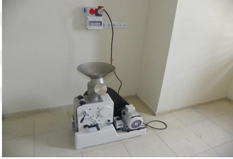
Şekil 4.3. Fritsch Pulverisette 1 çeneli kırıcı
