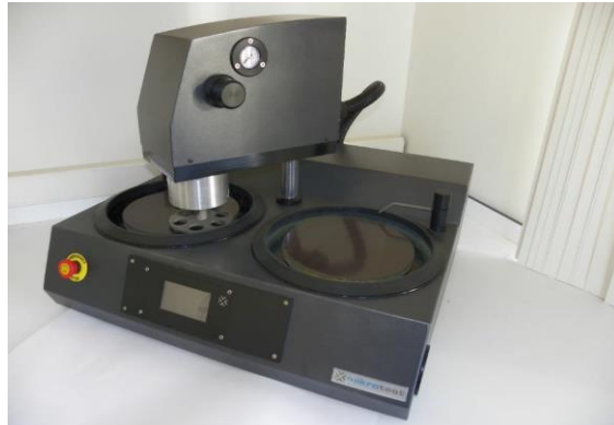
Şekil 4.12. Mikrotest yarı otomatik zımparalama ve parlatma cihazı
