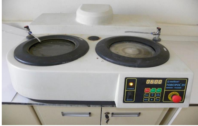
Şekil 4.9. Metkon Forcipol 2V zımparalama ve parlatma cihazı
