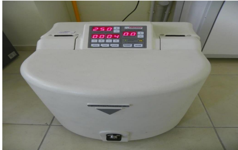
Şekil 4.4. Fritsch Pulverisette 6 bilyalı öğütücü
