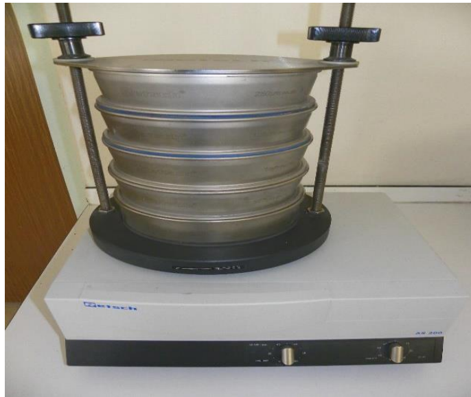
Şekil 4.7. Retsch AS 200 sallayıcı ve elekleri
