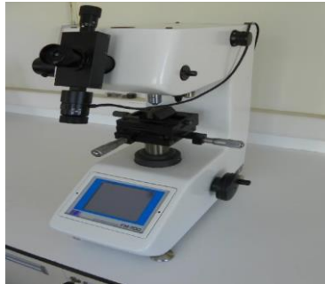
Şekil 4.15. Future Tech FM-700 mikrosertlik cihazı
