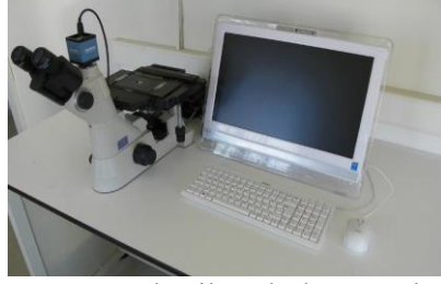
Şekil 4.13. Nikon MA 100 ters metal mikroskobu ve Clemex görüntü analiz sistemi
