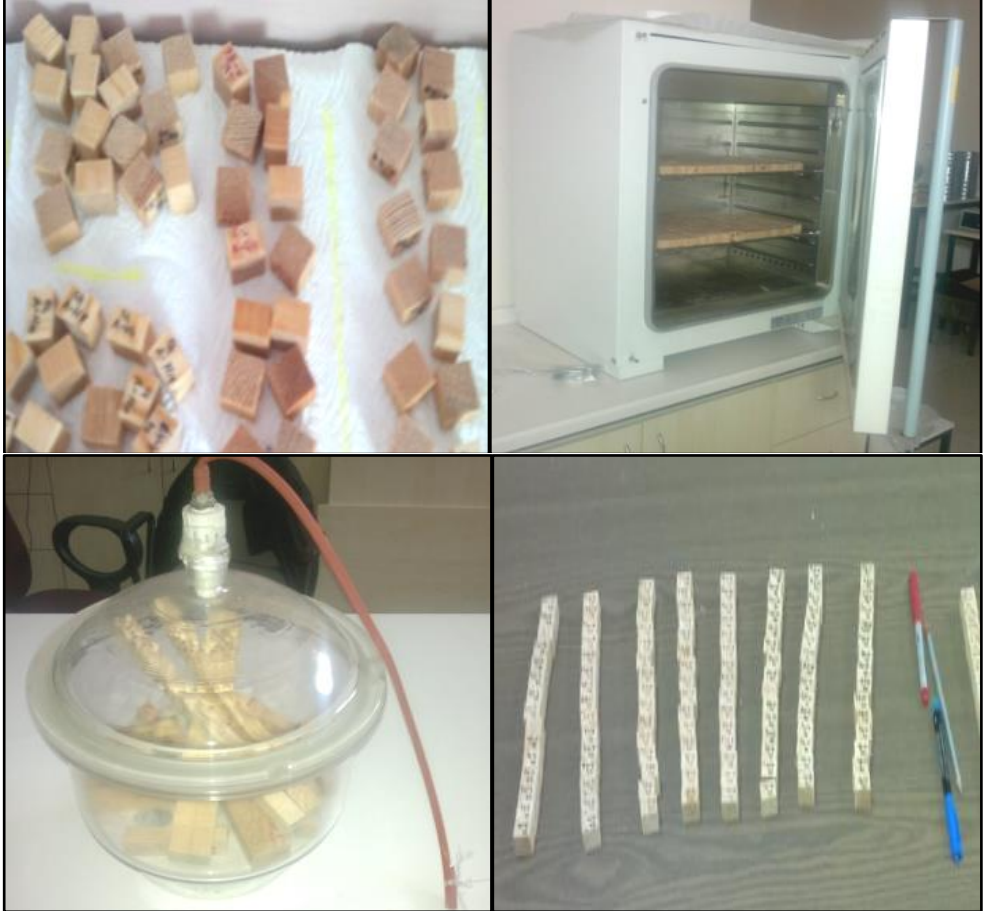
Şekil 3.4. Örneklerin fiziki ölçümlerinin yapıpı tam kuru hale getirilmesi
