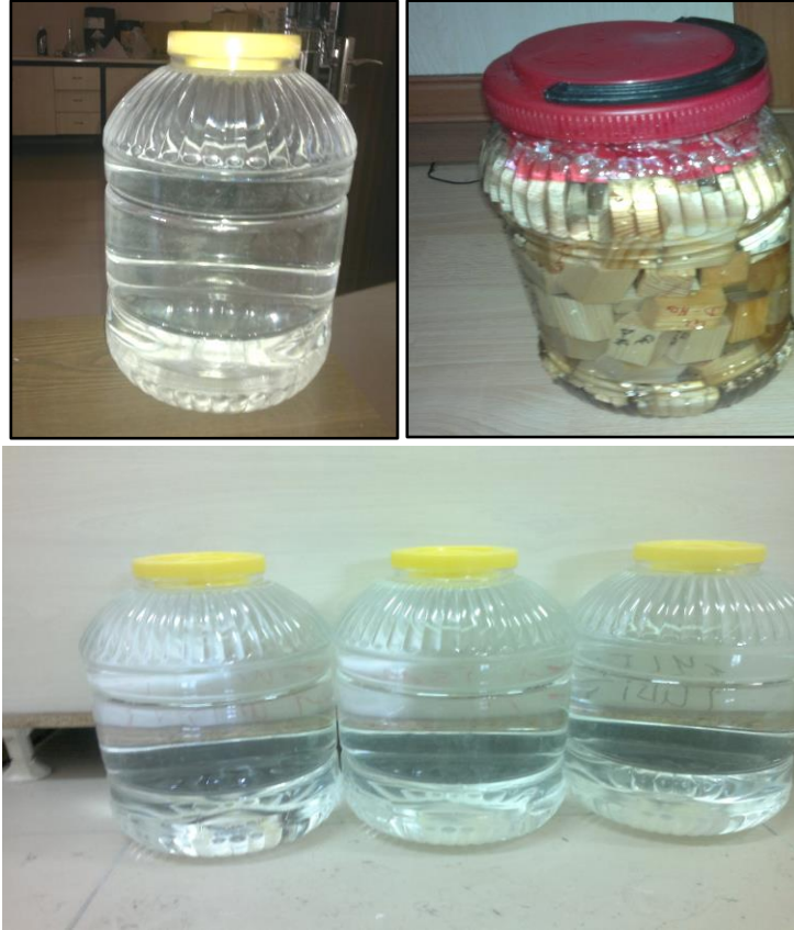
Şekil 3.3. Örneklerin jeotermal kaynaklarla emprenye uygulaması
