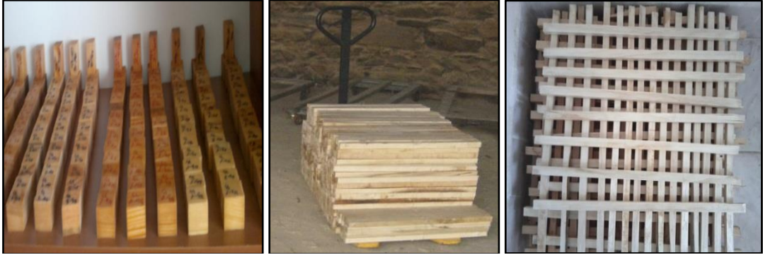
Şekil 3.1. Örneklerin hazırlanması ve kurutulması
