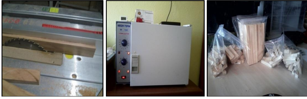
Şekil 3.2. Örneklerin hazırlanması ve tam kuru hale getirilerek saklanması
