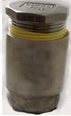
Şekil 5.1 Paslanmaz çelik sızdırmaz su soğutmalı pota
