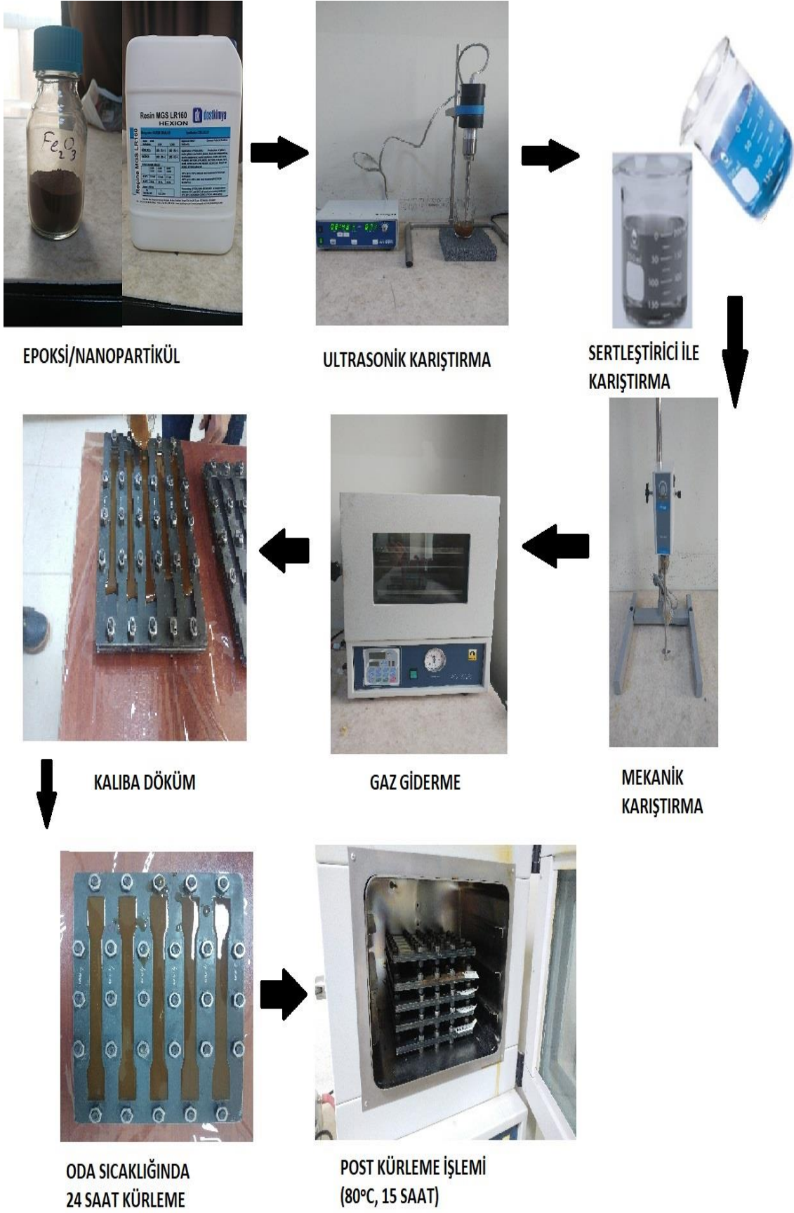
Şekil 4.3. Çekme numunesi üretim aşamaları
