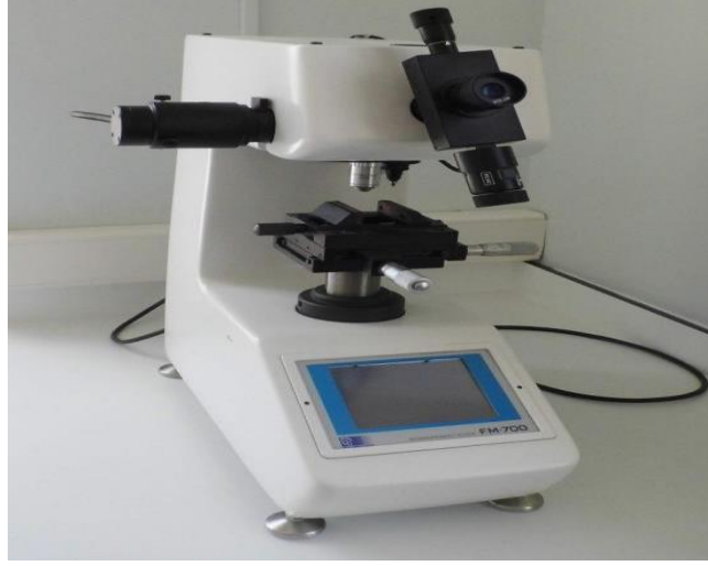
Şekil 5.8. Mikrosertlik ölçüm cihazı
