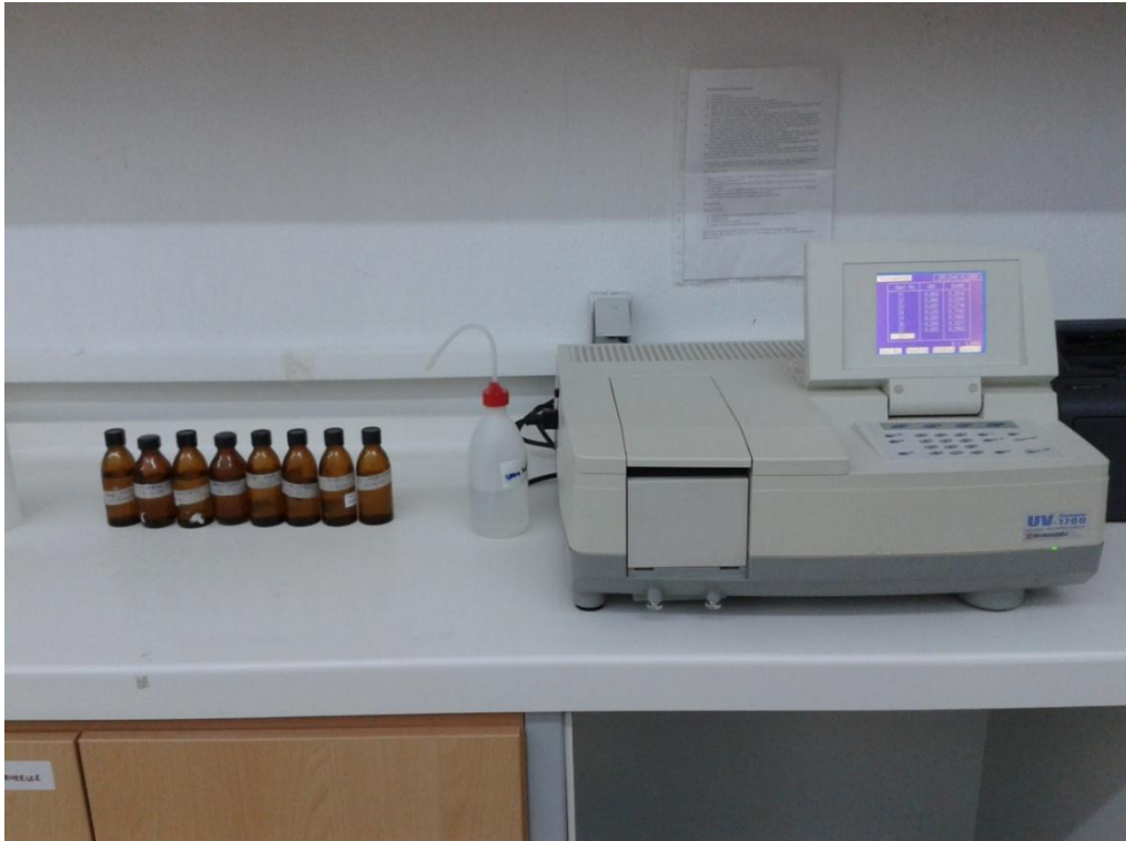
Şekil 3.5. Reaksiyon süresi sonunda alınan numunelerin laboratuvar ortamında UV 280 absorbanlarının ölçümü
