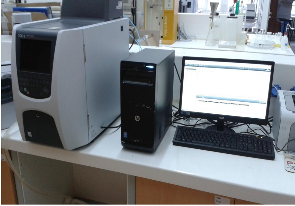
Şekil 3.4. Numunelerin ÇOK konsantrasyonunu belirlemek için kullanılan TOK analizörü
