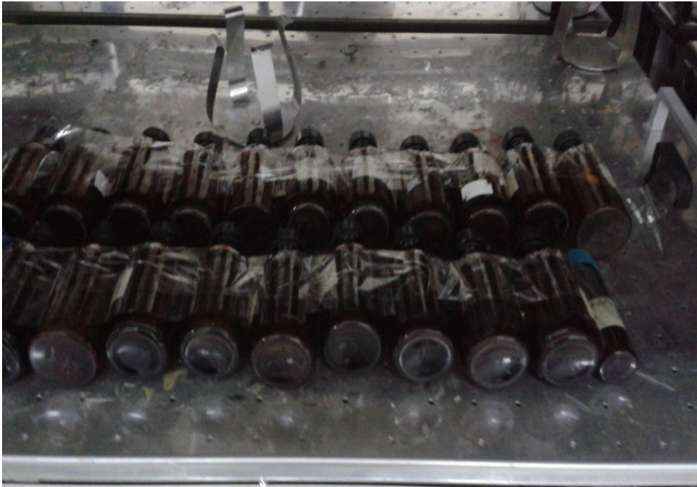
Şekil 3.6. Katalizör ve hidrojen peroksit dozlaması yapılan numunelerin orbital inkübatörde karıştırılması
