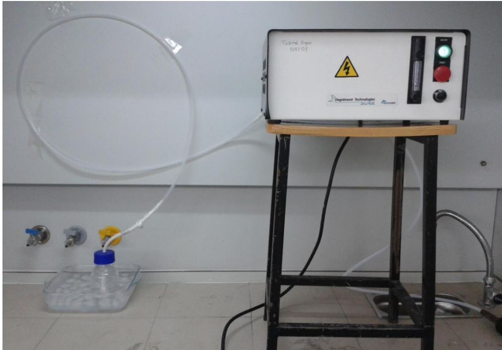
Şekil 3.7. Ozon jeneratörü ile ozon stok çözeltisinin hazırlanması için kurulan düzenek
