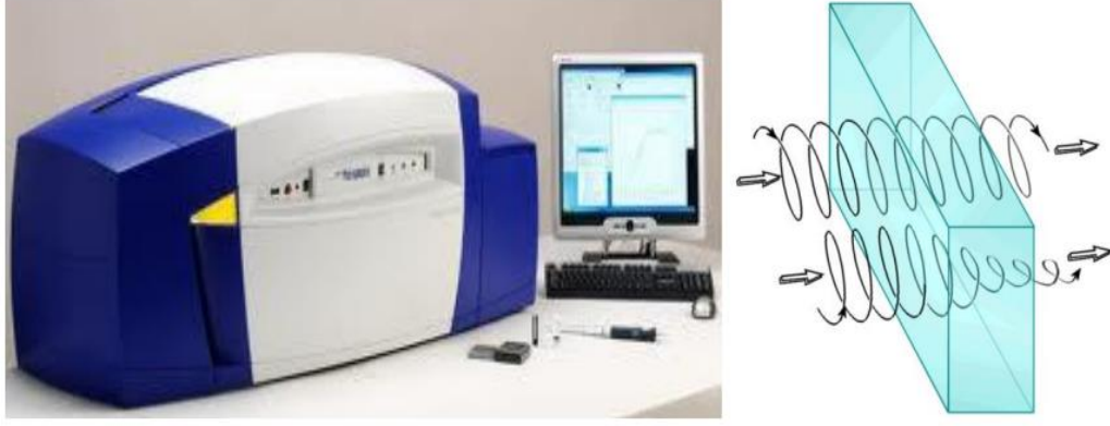
Şekil 1.15. Çevrimsel iki renklilik cihazı ve dairesel ışığa farklı absorpsiyon özelliği gösteren bir prizma
