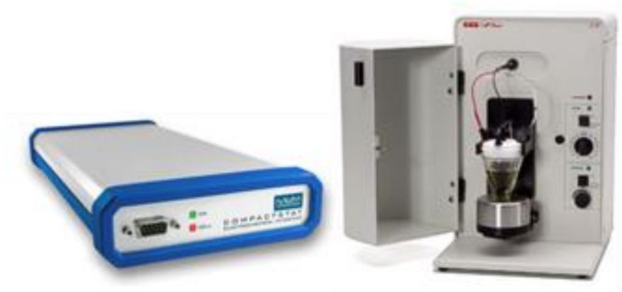
Şekil 3.1. Ivium CompactStat cihazı ve BASi C3 elektrokimyasal hücre standı
