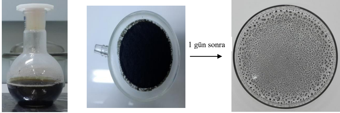
Şekil 4.10. rGO çözeltisi, süzme işlemi sonucunda rGO ve petri kabında kurutulmuş rGO
