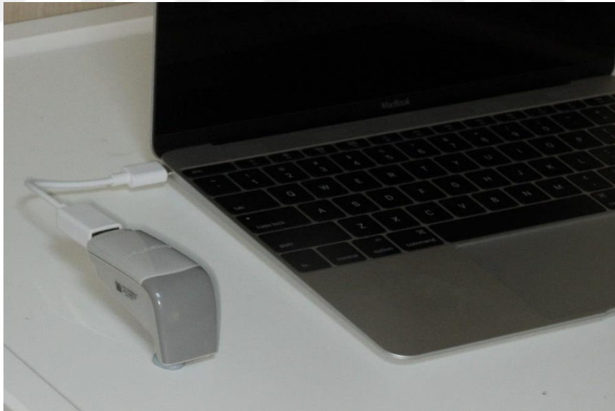
Şekil 3.5. Aktivatör kısmında bulunan USB girişi bilgisayara bağlanarak veriler elde edilmektedir
