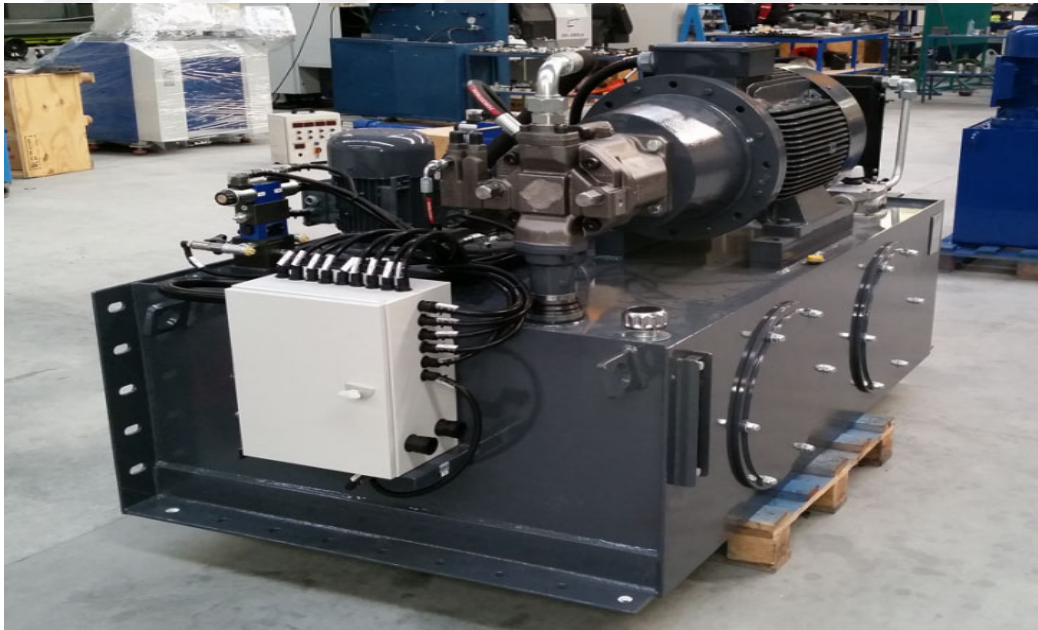
Şekil 4.4. Asenkron motor tahrikli hidrolik güç ünitesi
