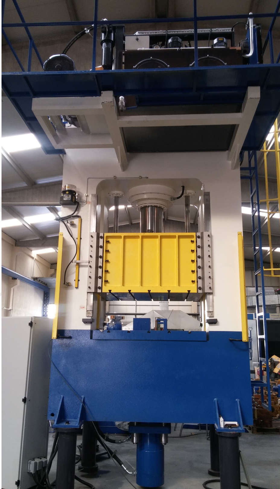
Şekil 4.2. Asenkron motor tahrikli 150 ton hidrolik derin çekme presi
