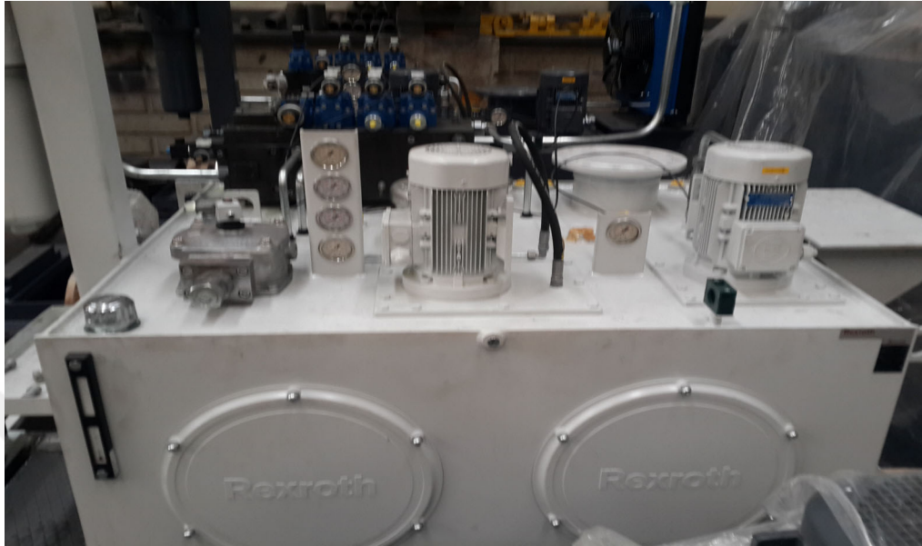
Şekil 4.3. Servo motor tahrikli hidrolik güç ünitesi
