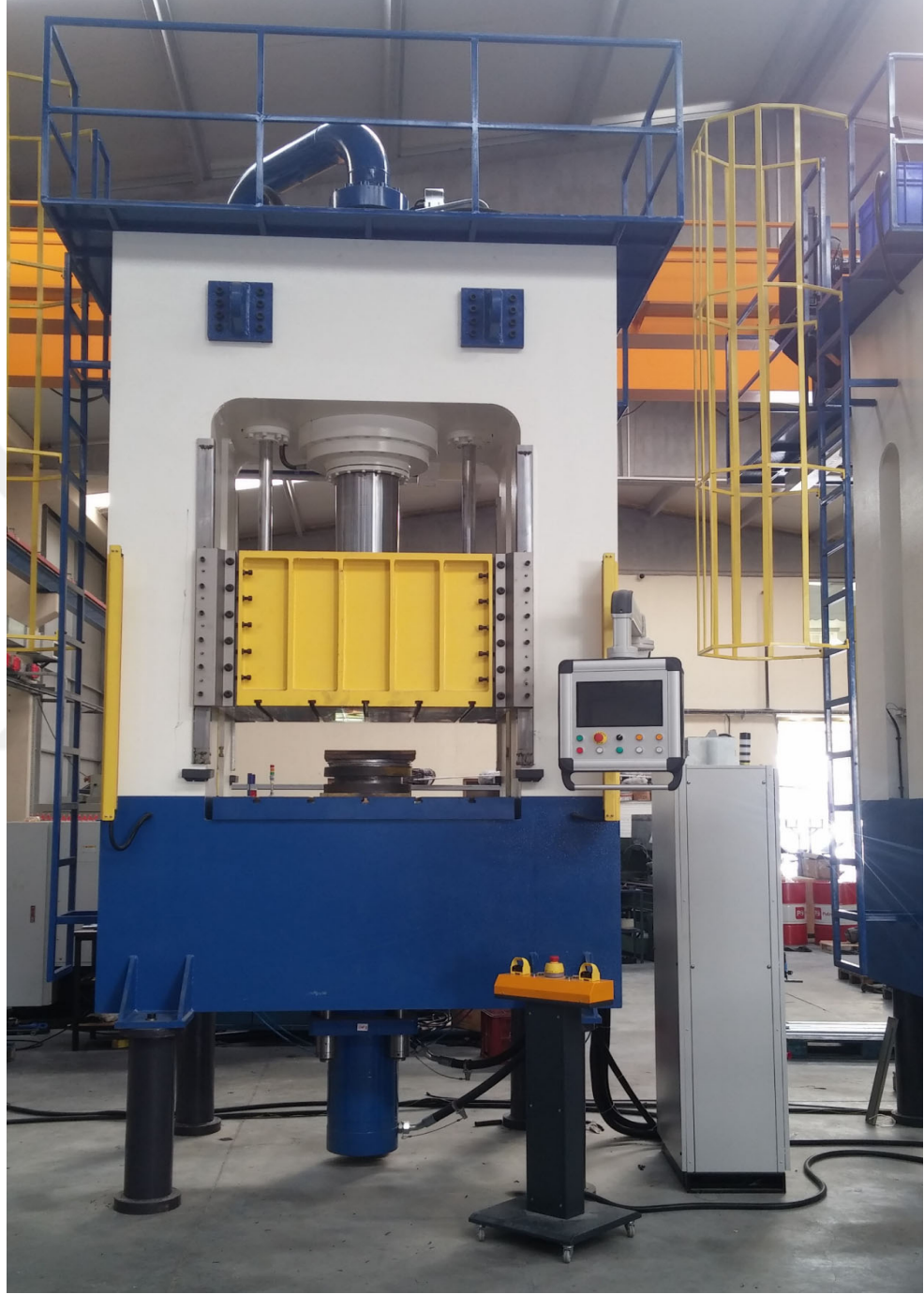
Şekil 4.1. Servo motor tahrikli 150 ton hidrolik derin çekme presi
