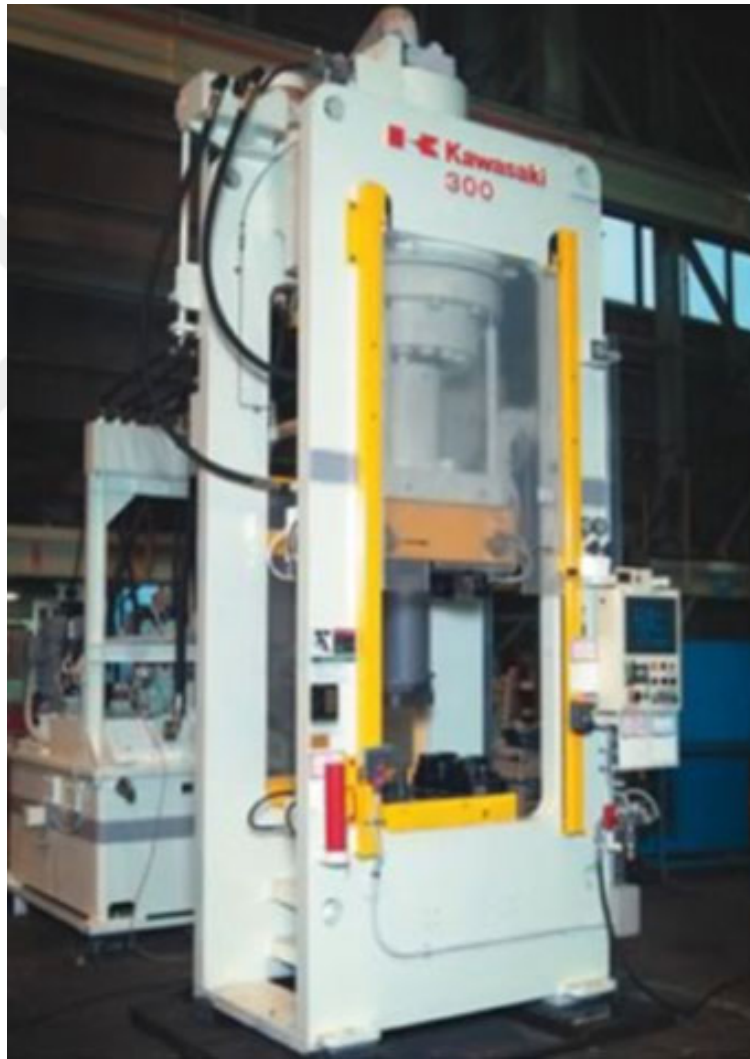
Şekil 2.1. Kawasaki hidromekanik tarafından yapılmış hidrolik servo pres
