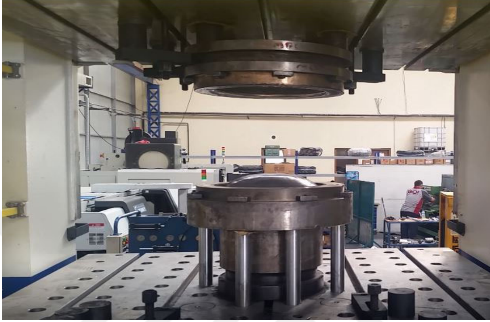
Şekil 4.5. Preslerin sac şekillendirme öncesi tipik kalıp görüntüsü
