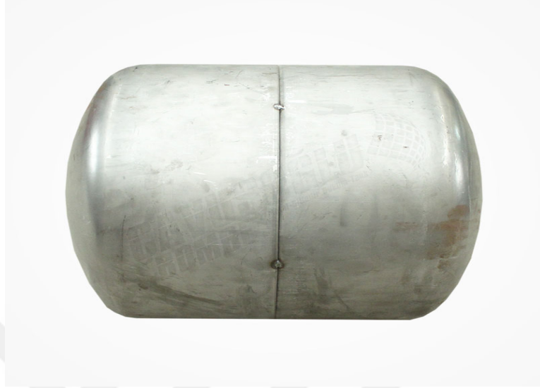
Şekil 4.7. Preslerin sac şekillendirme işlemi sonrası görüntüsü
