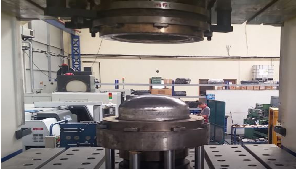
Şekil 4.6. Preslerin sac şekillendirme sonrası tipik kalıp görüntüsü
