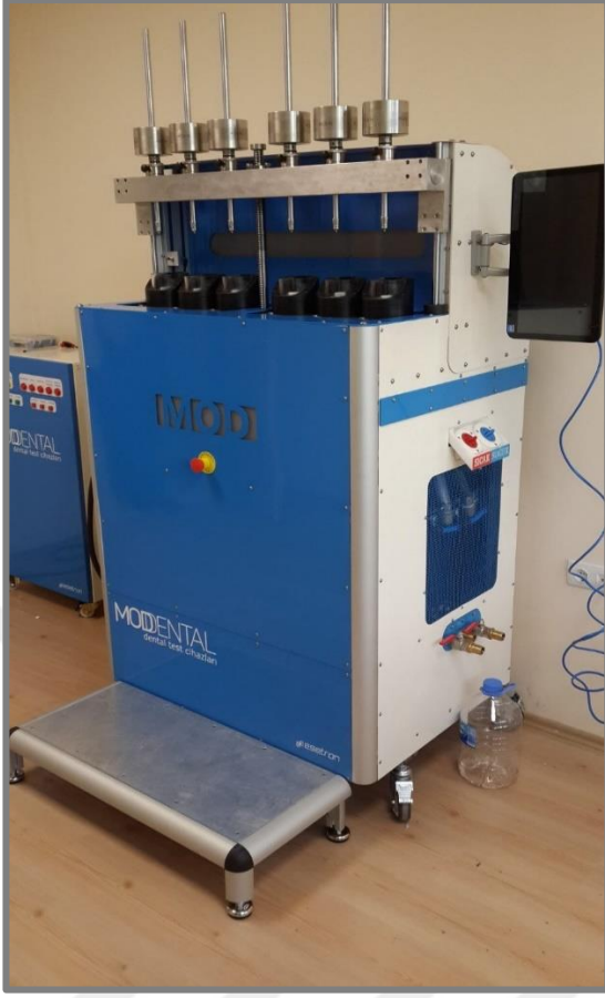
Şekil 3. 18. Termal siklus özelliği bulunan çiğneme simülatörü
