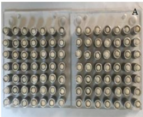
Şekil 3.4.1: A) Örneklerin termal siklus için hazırlanması, B) Çalışmada kullanılan termal siklus cihazı
