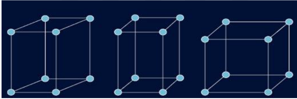
Şekil 2.3.2.1: Zirkonyanın m-t-k fazdaki kristal yapıları.(85)
