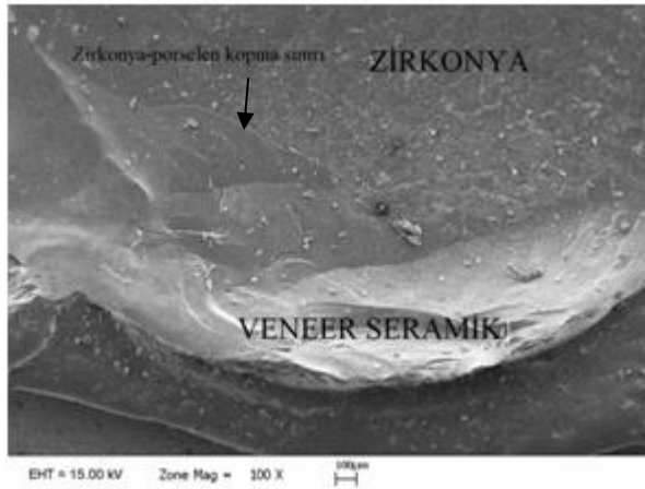
Şekil 4.4.1: Karışık kopma yüzeyinin SEM görüntüsü (x100)
