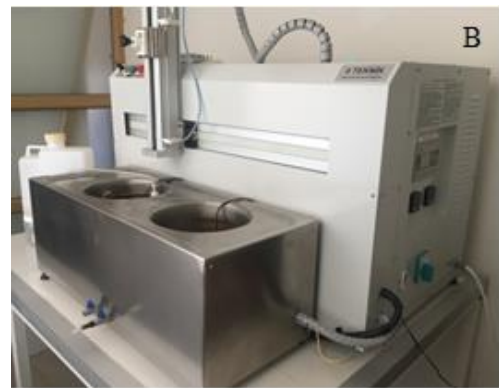
Şekil 3.4.1: A) Örneklerin termal siklus için hazırlanması, B) Çalışmada kullanılan termal siklus cihazı
