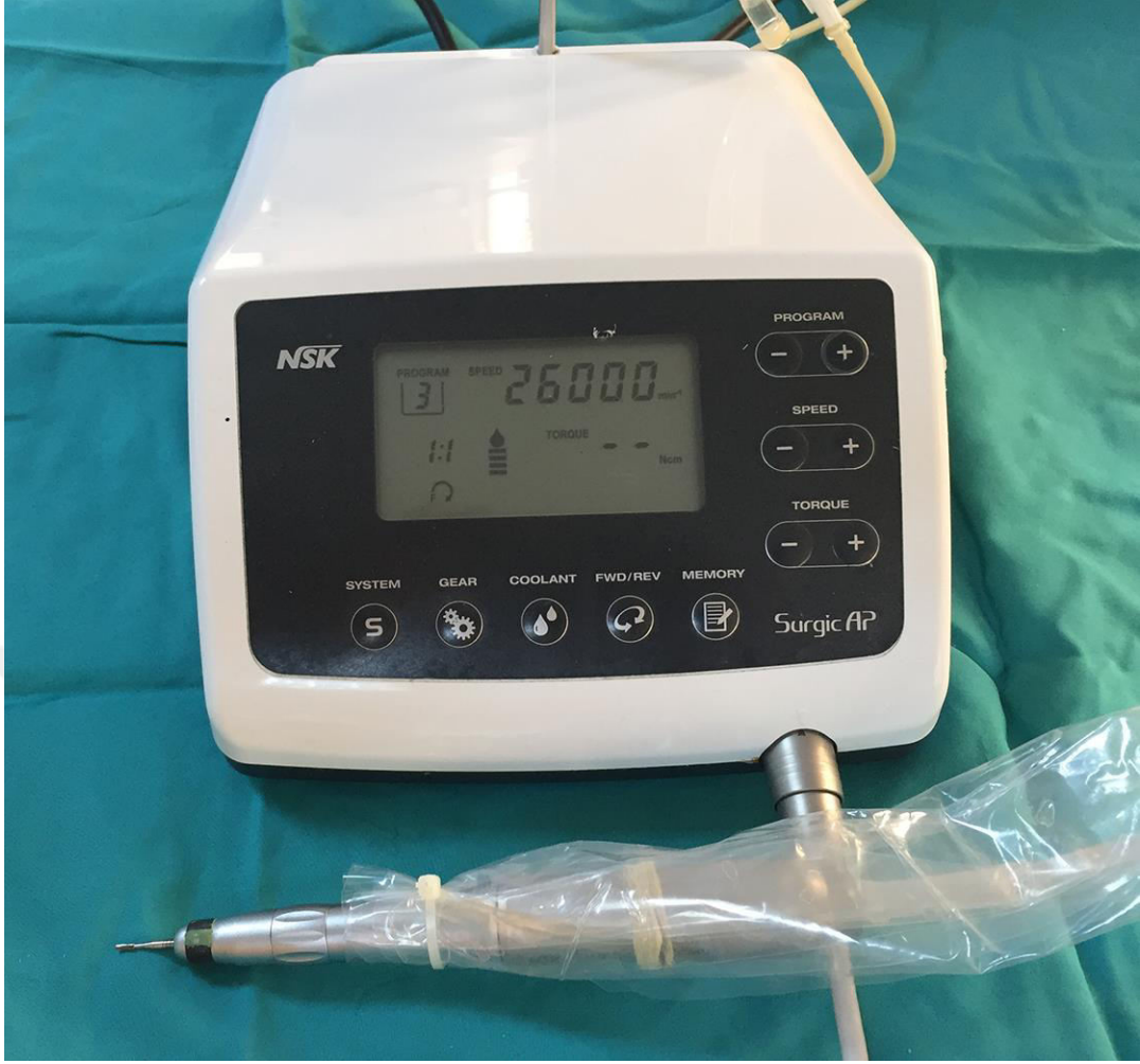
Şekil 3.4. 26000 rpm güçte ve maksimum irrigasyonda ayarlanan fizyodispenser cihazı, cerrahi başlık ve tungsten karbid fissür frez
