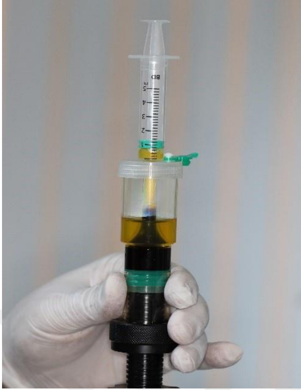
Şekil 3.5. Buffy coat kontrolörü çevrilerek trombositten zengin plazmanın (PRP) alınması.
