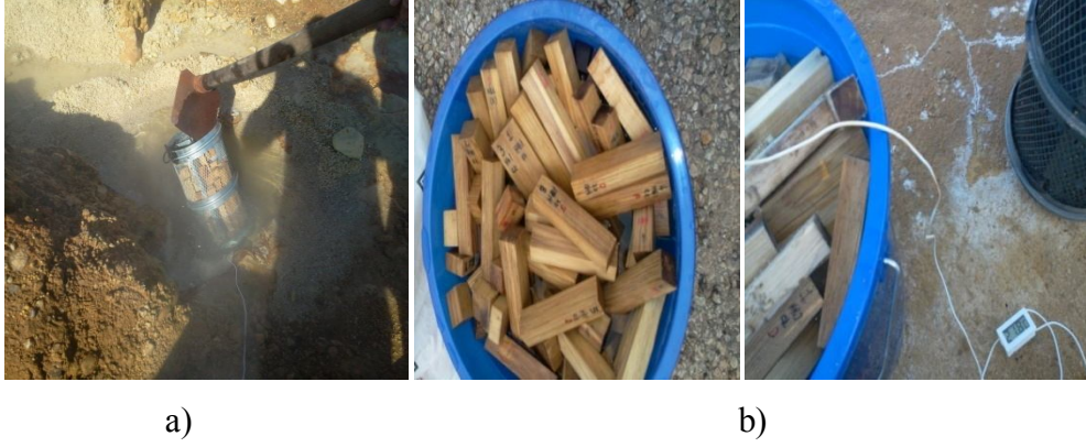
Şekil 3.7. Jeotermal kaynaklarda sıcak-soğuk daldırma işlemi (a: Sıcak suda daldırılma; b: Soğuk suda daldırılma)
