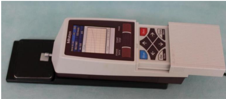
Şekil 3.1.3.1. Çalışmada kullanılan profilometre cihazı ile yüzey pürüzlülüklerinin ölçülmesi
