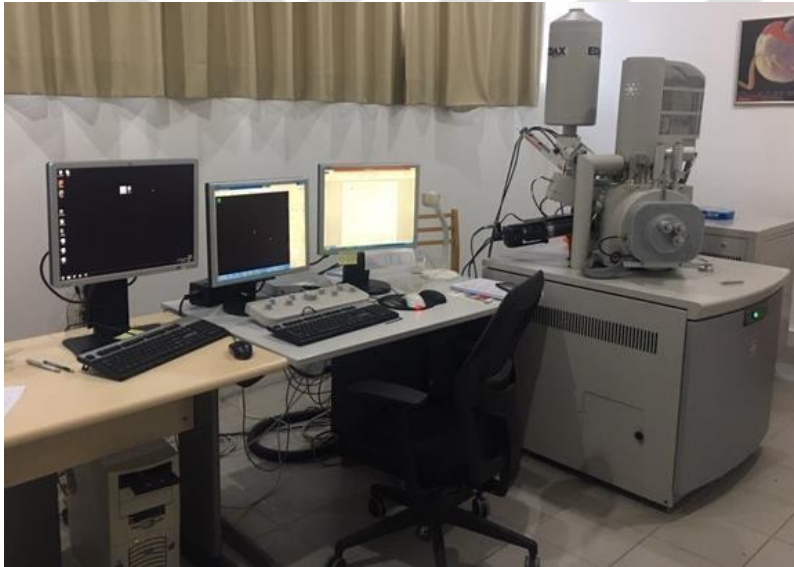
Şekil 3.5.3. SEM görüntülerinin ve EDS analizinin yapıldığı QUANTA 400F Alan Emisyon SEM cihazı
