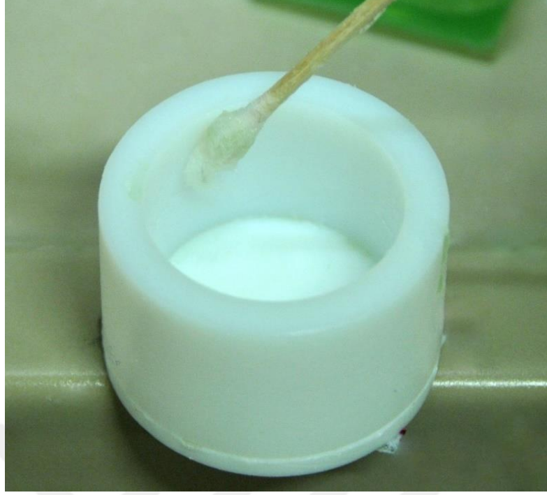
Şekil 3.7. PTFE'den hazırlanmış akrilik blok kalıpları.
