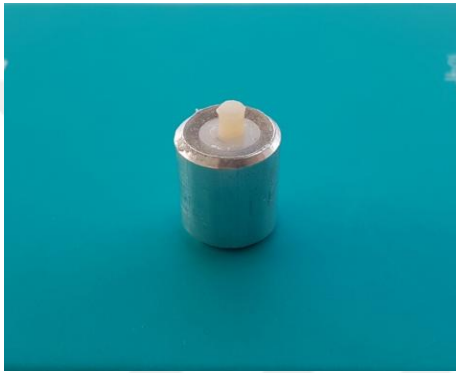
Şekil 3.5.2. Tamir malzemesi uygulanan örnek
