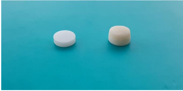
Şekil 3.2.4. 1,5 mm kalınlığındaki zirkonya altyapı ve porselen örnek
