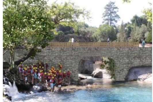
Şekil 4.29 Mevcut beton köprünün doğal taş kaplama önerisi
