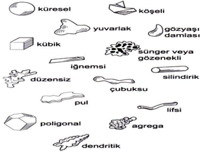
Şekil 2.2. Partikül şekilleri ve tanımları [2]
